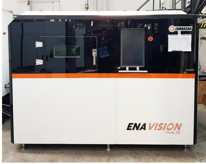
Şekil 7.3. Tüm numune üretimlerinin gerçekleştirildiği ENA 250 marka SLM tipi eklemeli imalat makinesi
