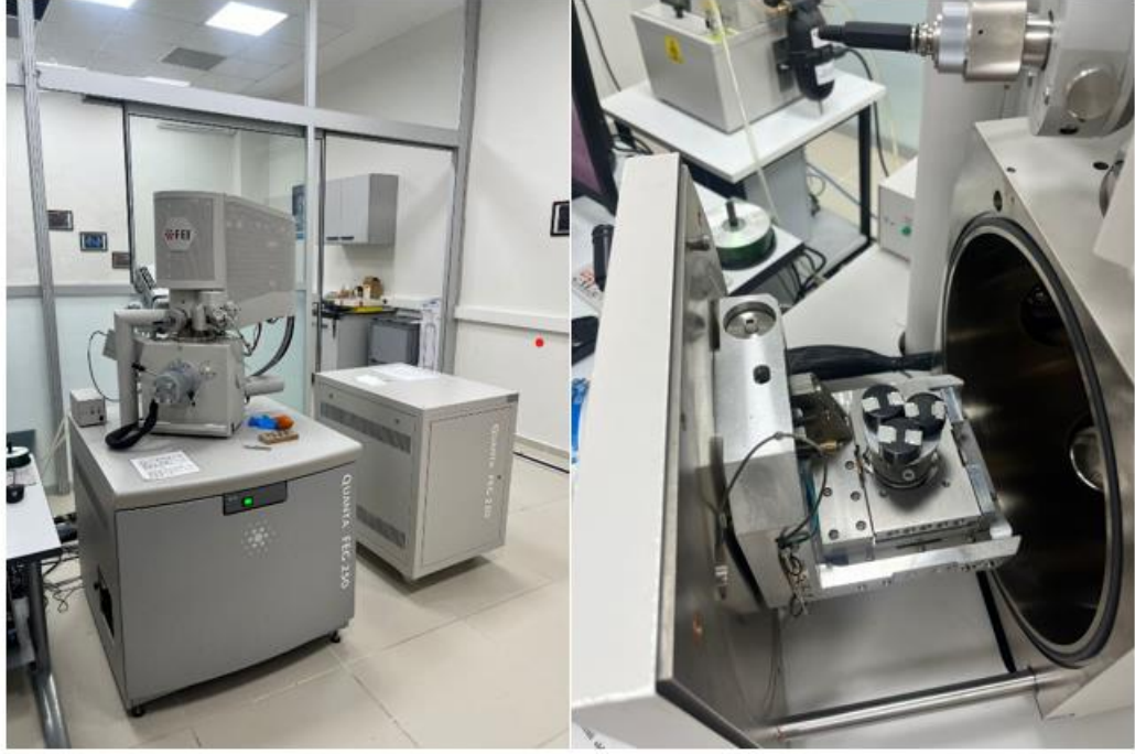
Şekil 7.21. İYTE SEM analiz cihazı ve numunelerin hazneye yerleştirilmesi
