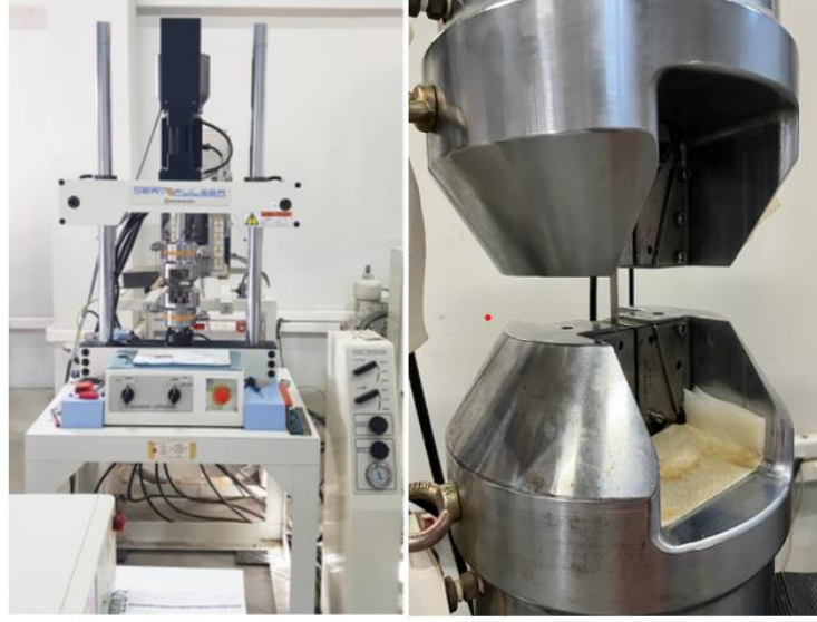
Şekil 7.23. (a) SHIMADZU marka EHF-LV020K2-020 model yorulma cihazı (b) çenelere numune bağlanması
