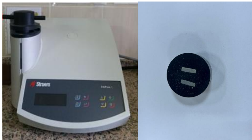
Şekil 7.18. a) Struers Citopress -1 bakalit cihazı, b) Bakalite alınmış bir numune örneği
