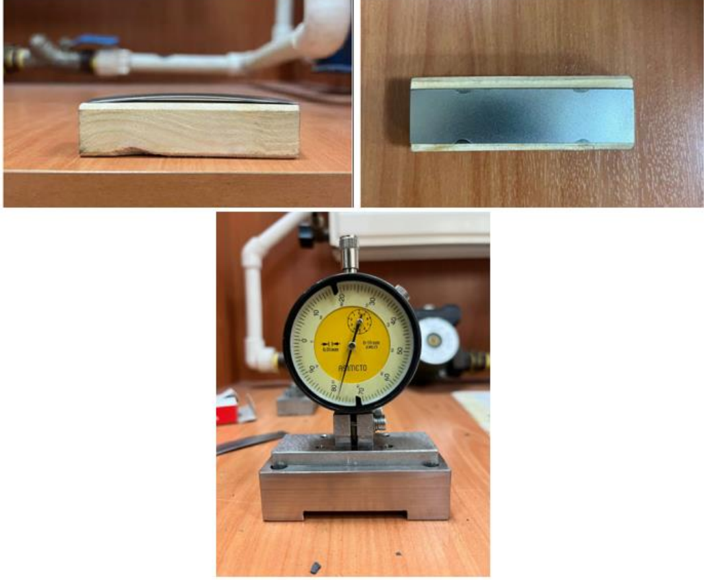
Şekil 7.13. Almen şiddeti ölçümü için bilyalı dövülmüş N-tipi şeritler ve Almen şiddeti ölçümü
