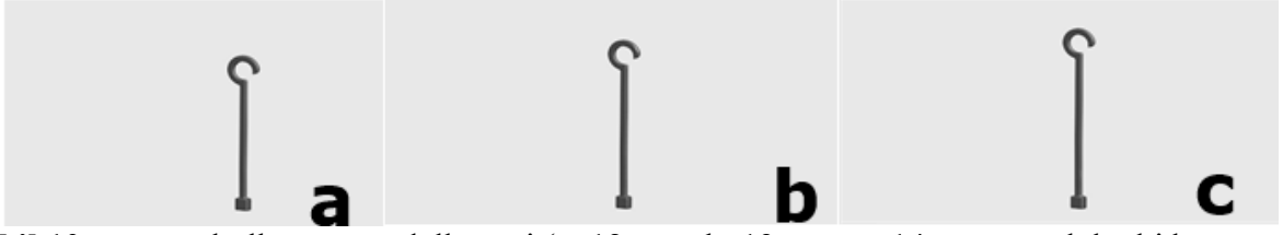
Şekil 10. Kuvvet kollarının modellemesi (a: 12 mm, b: 13 mm, c: 14 mm uzunluktaki kuvvet kolu)
