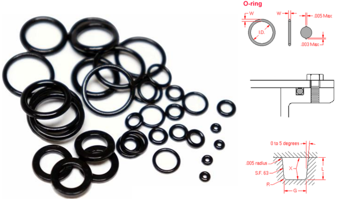
Resim 3.31 a)o-ring b) kullanım yerleri [50]
