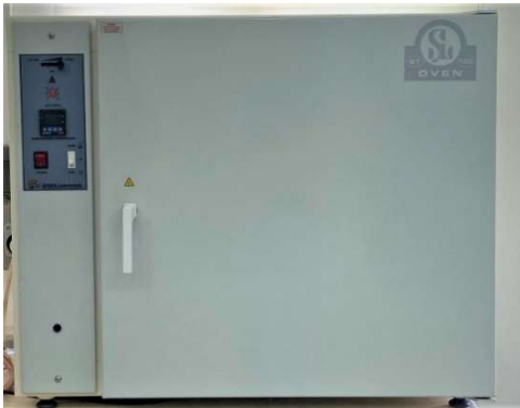
Şekil 3.3. Etüv kurutucu (Şimşek Laborteknik, ST-120), Türkiye.
