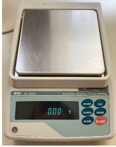
Şekil 3.2. Hassas terazi (Şimşek Laborteknik, AND GF- 3000) Türkiye
