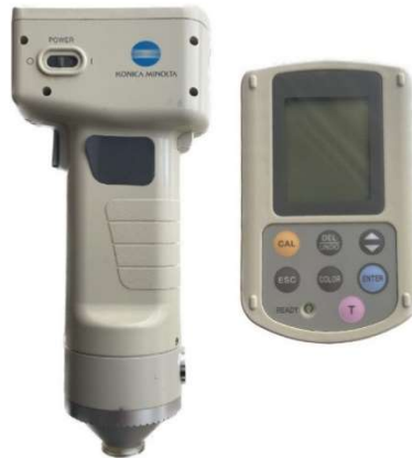
Şekil 3.7. Renk ölçüm cihazı (Minolta, CR300), Japonya.
