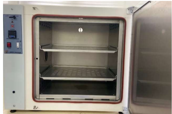
Şekil 3.3. Etüv kurutucu (Şimşek Laborteknik, ST-120), Türkiye.
