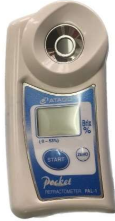
Şekil 3.9. Refraktometre (ATAGO, Pocket Refractometer PAL-1), ABD.
