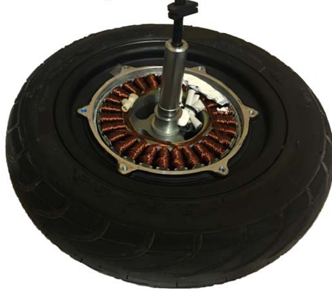
Şekil 3.17 Tekerlek içerisine gömülü FDAM.
