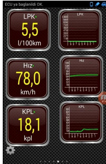
Şekil 2.57 80 [km/h] sabit hız ile yapılan test için yakıt tüketim değerleri (Kişisel arşiv, 2017)
