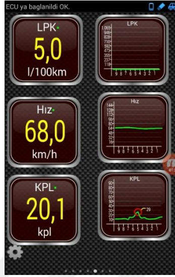
Şekil 2.56 70 [km/h] sabit hız ile yapılan test için yakıt tüketim değerleri (Kişisel arşiv, 2017)
