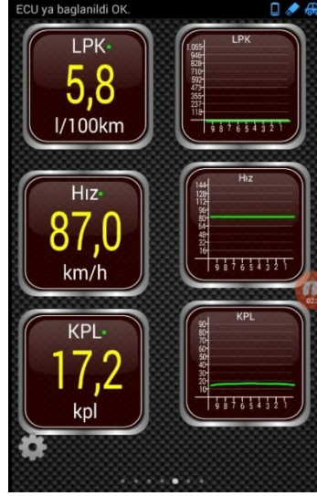
Şekil 2.58 90 [km/h] sabit hız ile yapılan test için yakıt tüketim değerleri (Kişisel arşiv, 2017)
