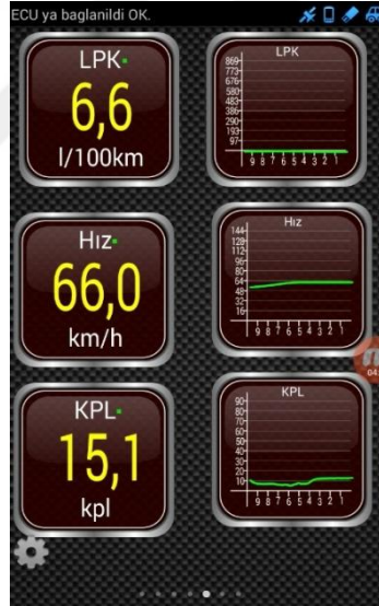
Şekil 2.53 70 [km/h] sabit hız ile yapılan test için yakıt tüketim değerleri (Kişisel arşiv, 2017)
