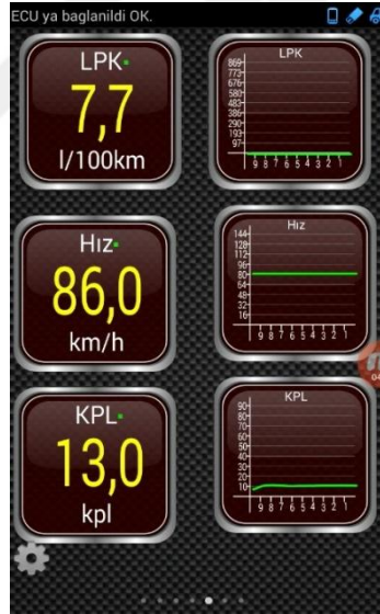
Şekil 2.55 90 [km/h]sabit hız ile yapılan test için yakıt tüketim değerleri (Kişisel arşiv, 2017)
