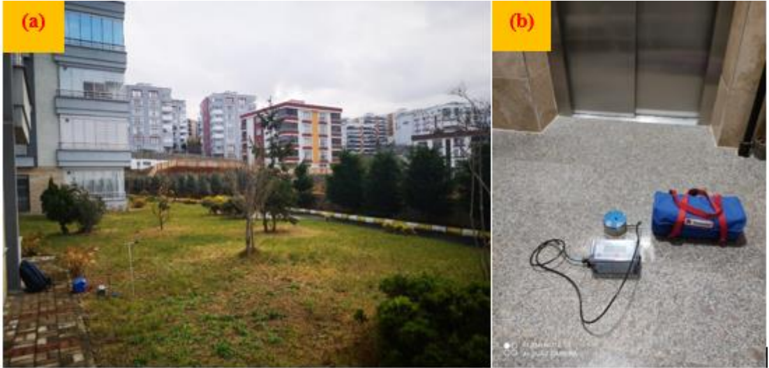
Şekil 10. Patlatmalardan kaynaklı titreşimlerin Ayyapı Bostancı-1 Zirve Sitesi Bloklarının dış zemininde (a) ve son kat döşemesinde (b) ölçümü
