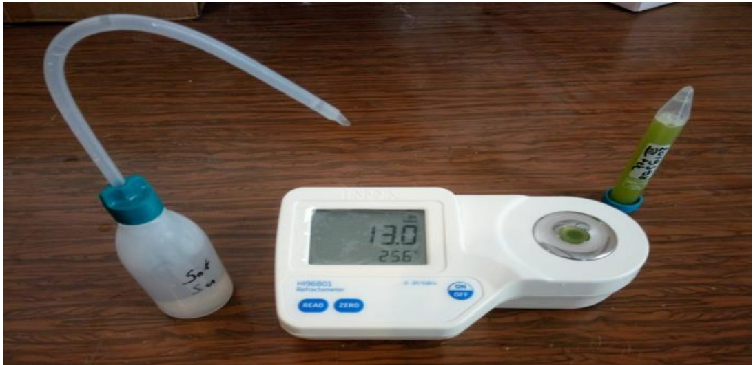
Şekil 3.19. El refraktometresi ile Brix ölçümü
