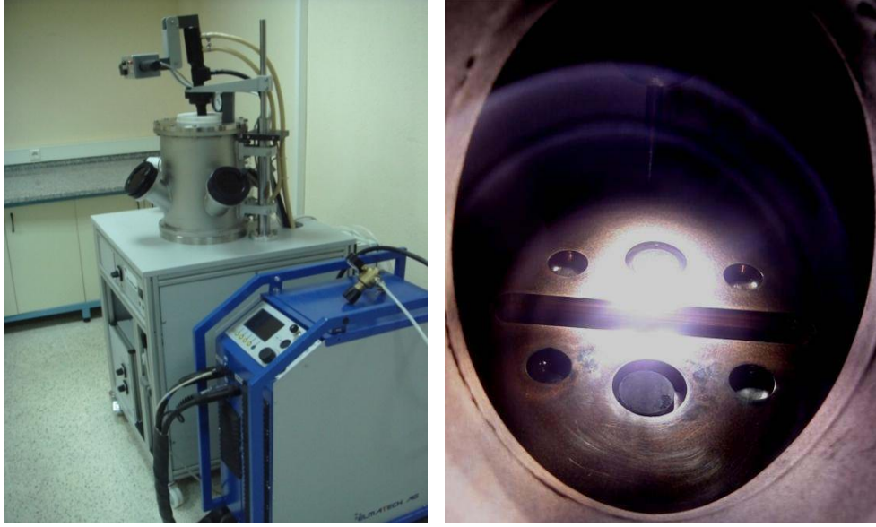
Şekil 5.2 Döküm işleminin yapıldığı vakum ark ergitme cihazının (a) dış görünüşü ile destek ekipmanları, (b) içindeki döküm potaları
