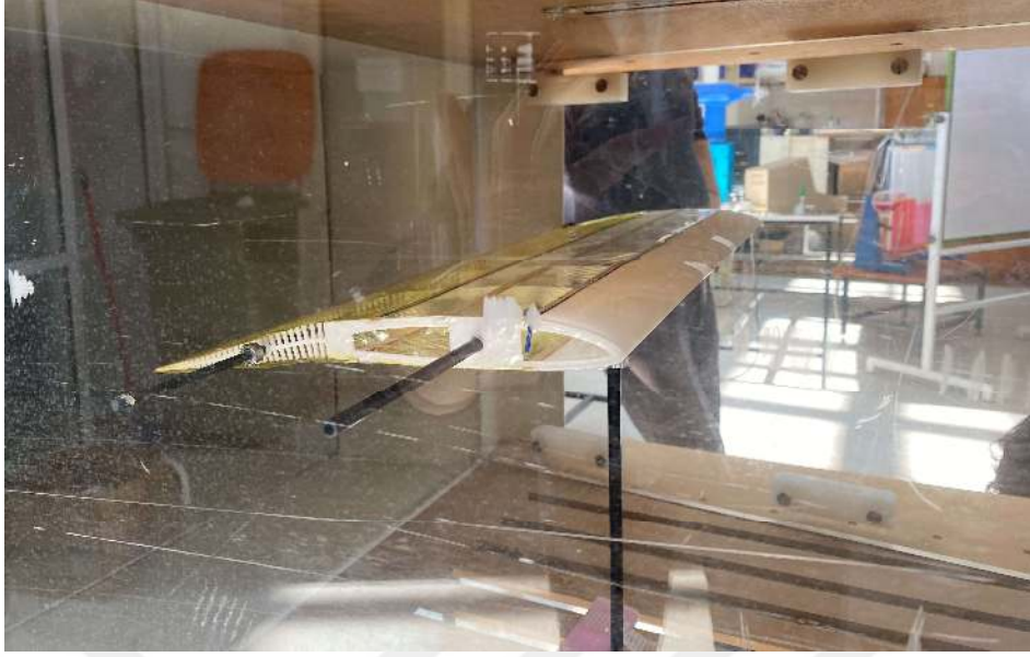
Görsel 7.8. Test parçası 2 rüzgâr tüneli testleri
