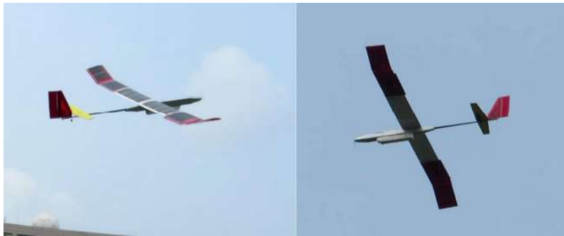
Görsel 2.23. Güneş enerjili İHA’nın N kanat dihedral değişimi [88]
