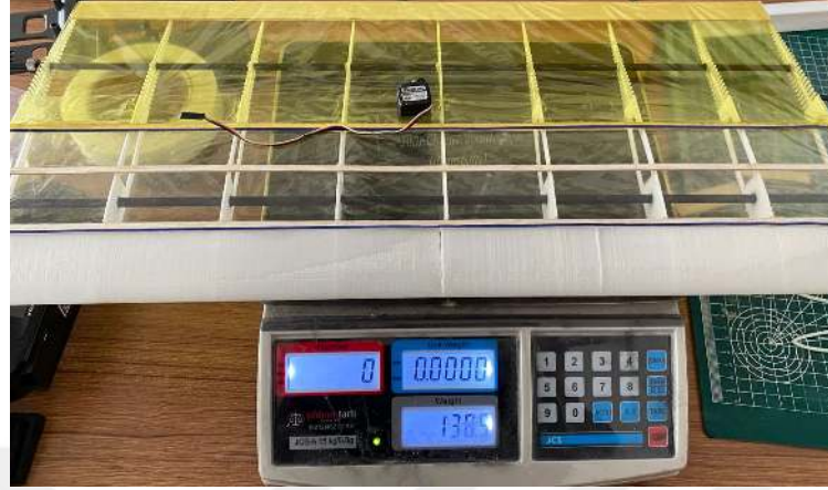
Görsel 9.3. Şekil değiştiren kanadın konvansiyonel servomotoru ile ağırlığı
