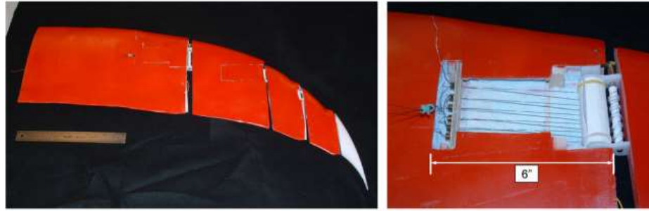
Görsel 2.24. HECS kanat tasarımı ve şekil hafızalı tel kompartımanı [91]
