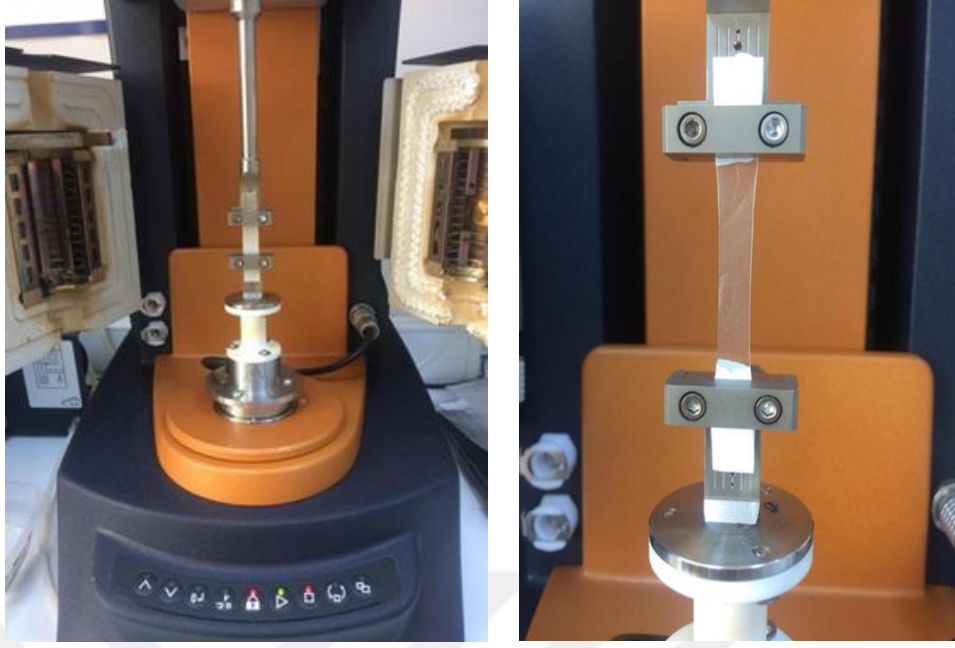
Şekil 4.9. Şekil hafıza testinde numunenin test öncesi ve test esnasındaki görüntüsü
