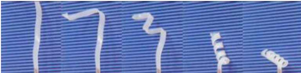
Şekil 2.2. Termoplastik şekil hafıza özelliğine sahip polimerin şekil hatırlama diyagramı [5]
