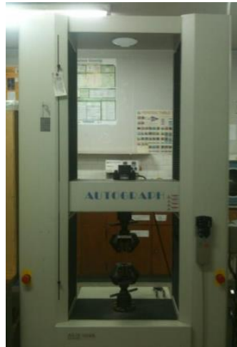
Şekil 4.11. Üniversal çekme-kopma test cihazı
