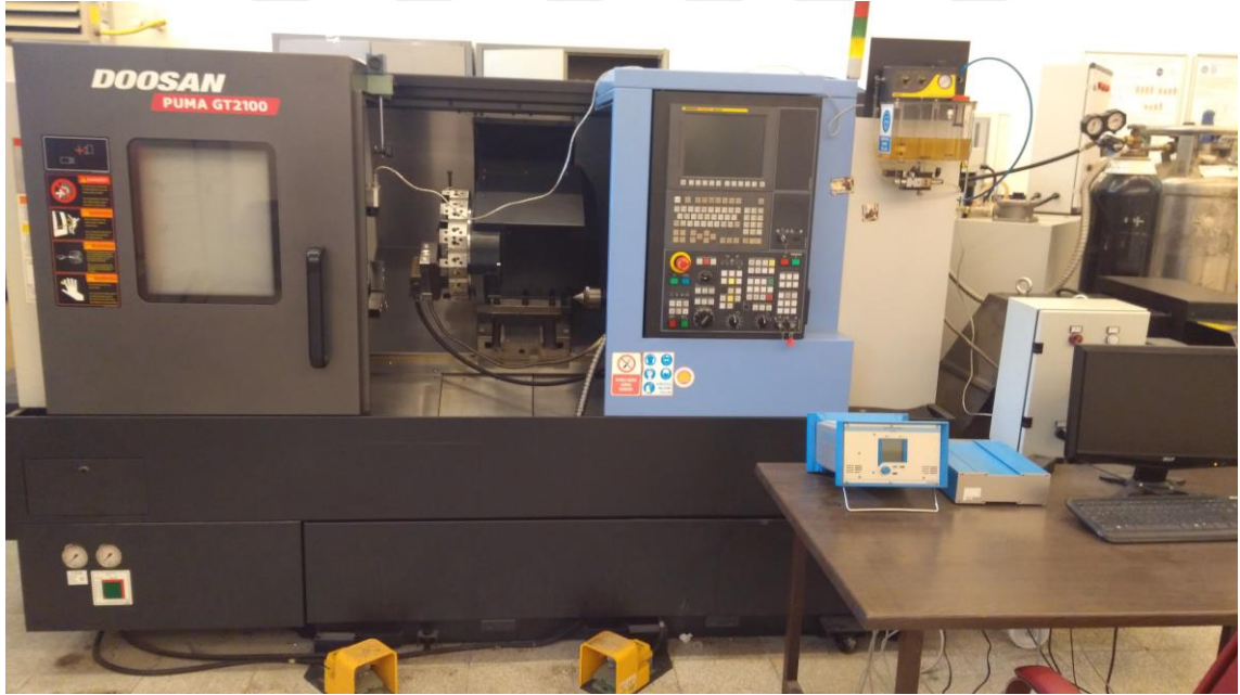
Şekil 2.3. Doosan Puma GT2100 CNC torna tezgahı
