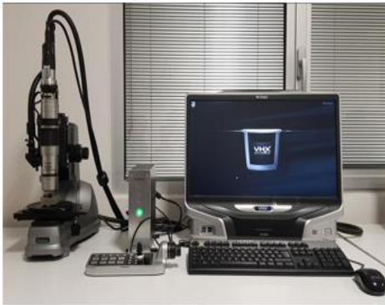
Şekil 2.11. Mikroyapı ve takım aşınması görüntülerinin alındığı dijital optik mikroskop
