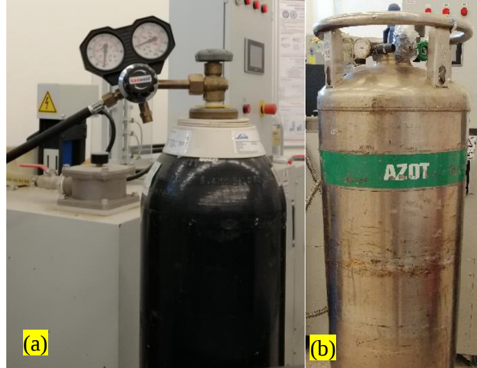
Şekil 2.8. CO 2 (a) ve Sıvı azot (LN 2 – Liquid Nitrogen) (b) tüpü ve bağlantı ekipmanları
