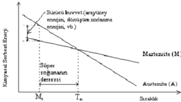
Şekil 2.6. Austenite ve martensite fazın kimyasal serbest enerjilerinin sıcaklık ve martensitik dönüşümle ilişkisi
