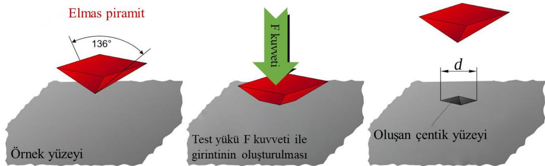
Şekil 3.19. Vicker’s sertlik testi çalışma prensibi
