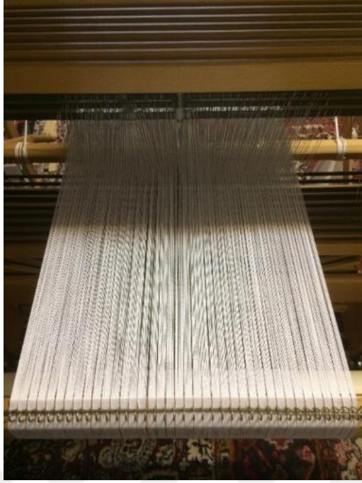
Resim 267. Çözü İpliklerinin Arka Levende Görünümü-Deneme 1
