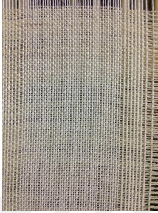
Resim 444. Atkı İpliği: Yün No 20 - Tarak Raporu 0,2,2,0 -Deneme 9
