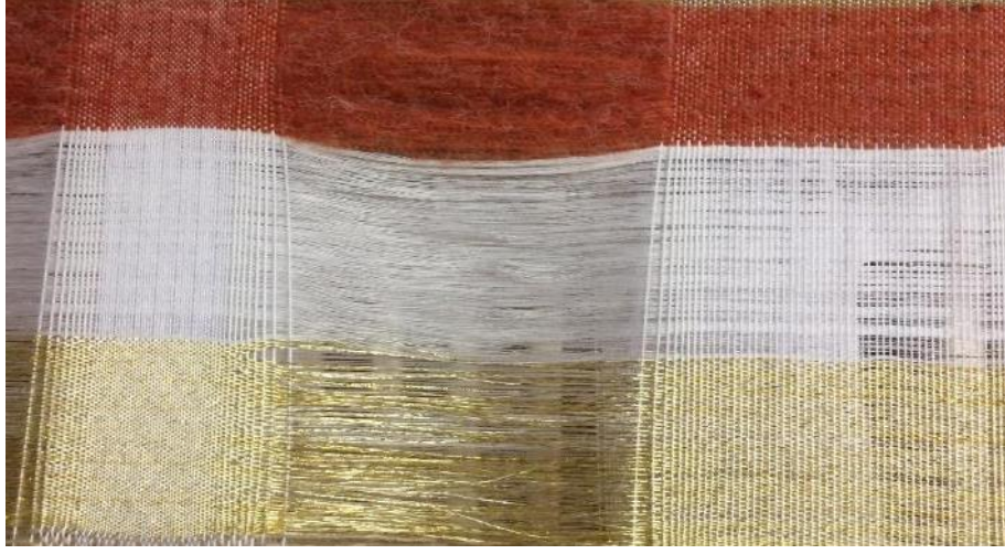
Resim 448. Atkı İplikler: Altın Simli, Bambu, Pürüzlü İplik- Deneme 9
