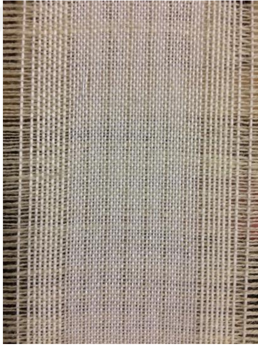
Resim 445. Atkı İpliği: Yün No 20 - Tarak Raporu 0,2,2,2,0-Deneme 9
