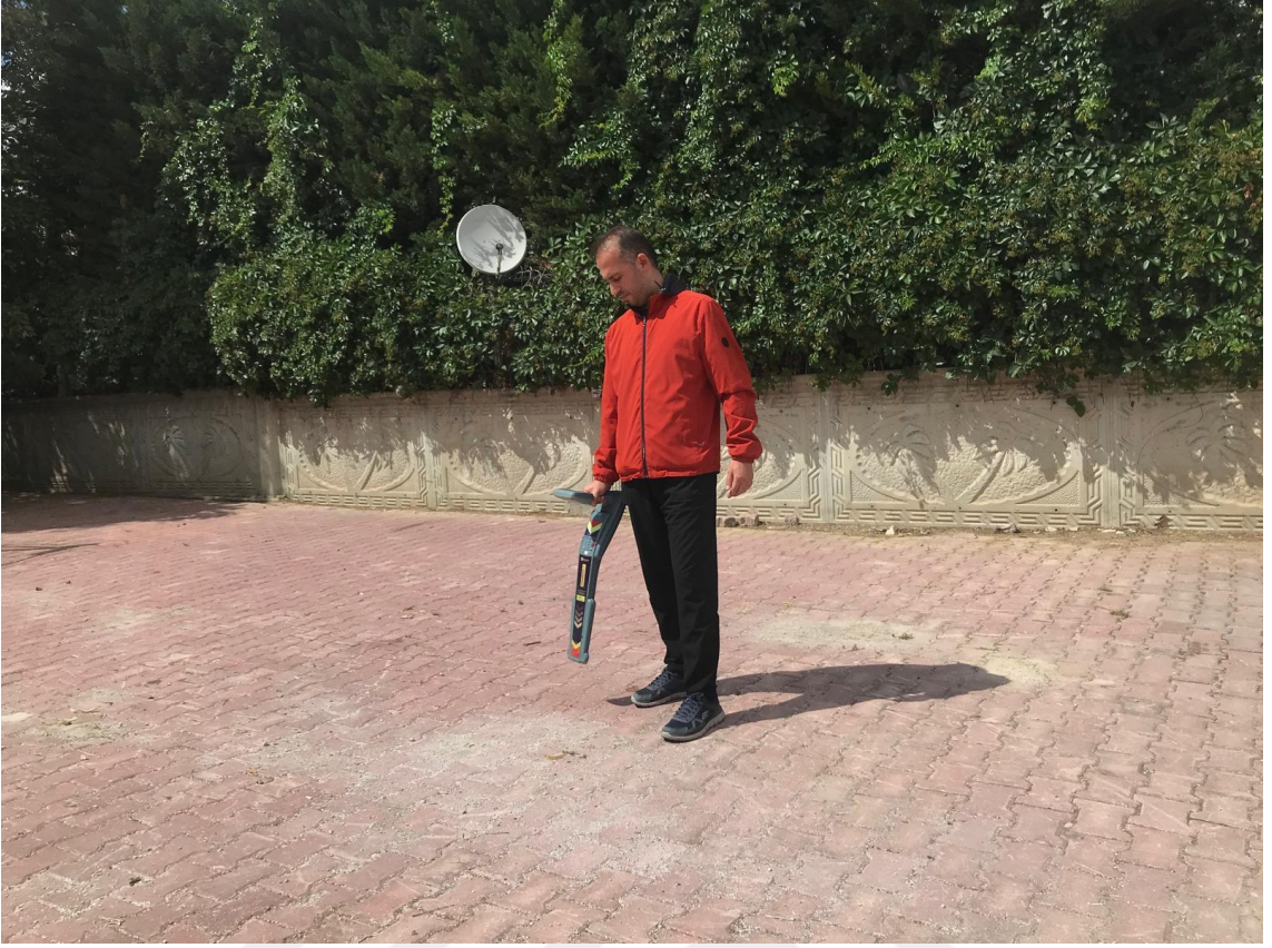
Şekil 5.20. Hat tespit cihazı ile tarama
