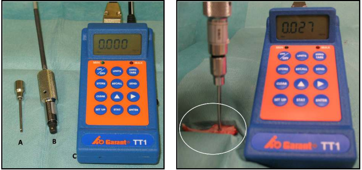
Şekil 25: A: Vidalar için uygun tornavida ucu arkası tork ölçer sensörüne uygun şekle getirilmiş; B: Tork ölçer sensörü; C: Tork ölçer.
