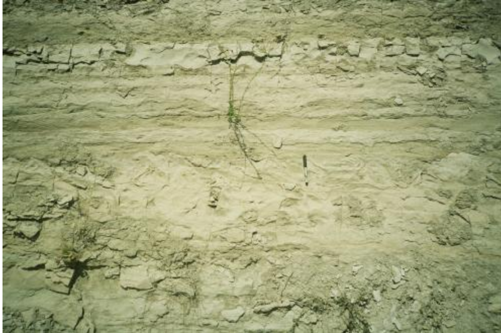
Şekil 3.9. Alut Üyesi içerisinde yer alan kumlu silttaşı – silttaşı – gri kiltası fasiyesi içerisinde gelişmiş karışık tabakalar.
