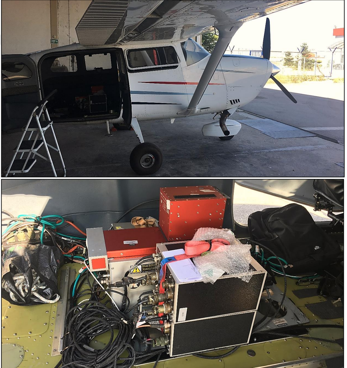
Şekil 9: Hava LiDAR sisteminin uçağa montajı.
