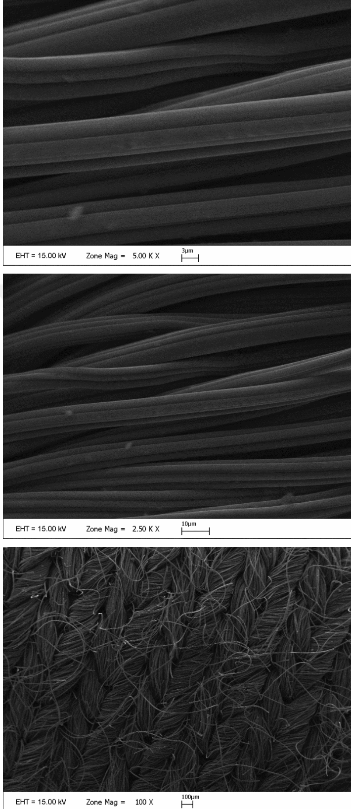
řekil 4.17. 1 M H_3PO_4 ve 0,5 M ZnCl_2 emdirilerek üretilen aktif karbon kumařına (AB9153) ait SEM görüntüsü (sırasıyla 5000X, 2500X ve 100X büyütme)
