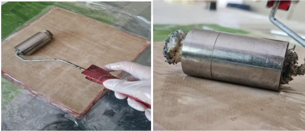
Şekil 3. 7. El yatırma tekniği ile dizilimin tamamlanması
