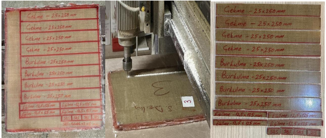
Şekil 3. 10. Kompozit tabakaların kesme işleminin yapıldığı CNC router cihazı
