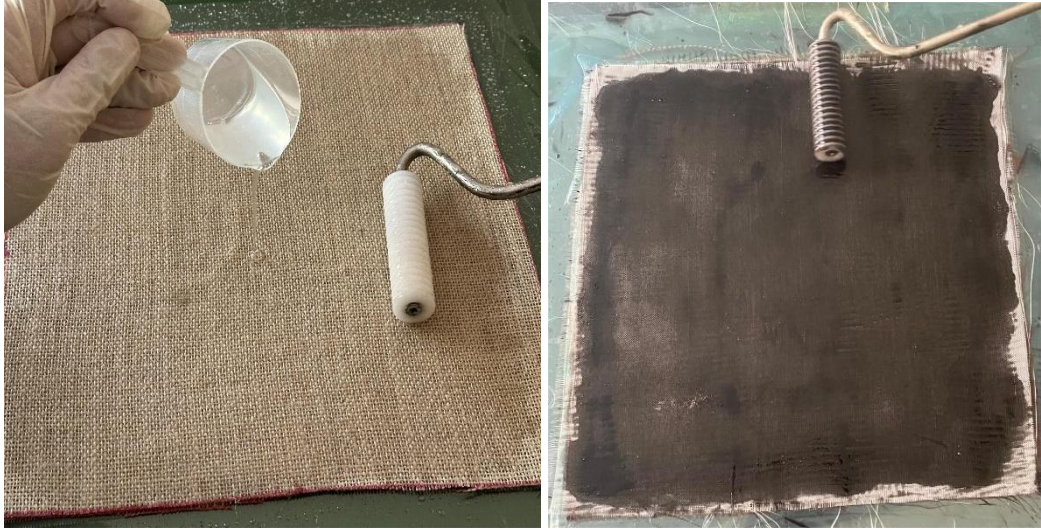
Şekil 3. 6. El yatırma tekniği ile toz karışımı olmayan ve toz karışımı kompozit plakaların üretilmesi
