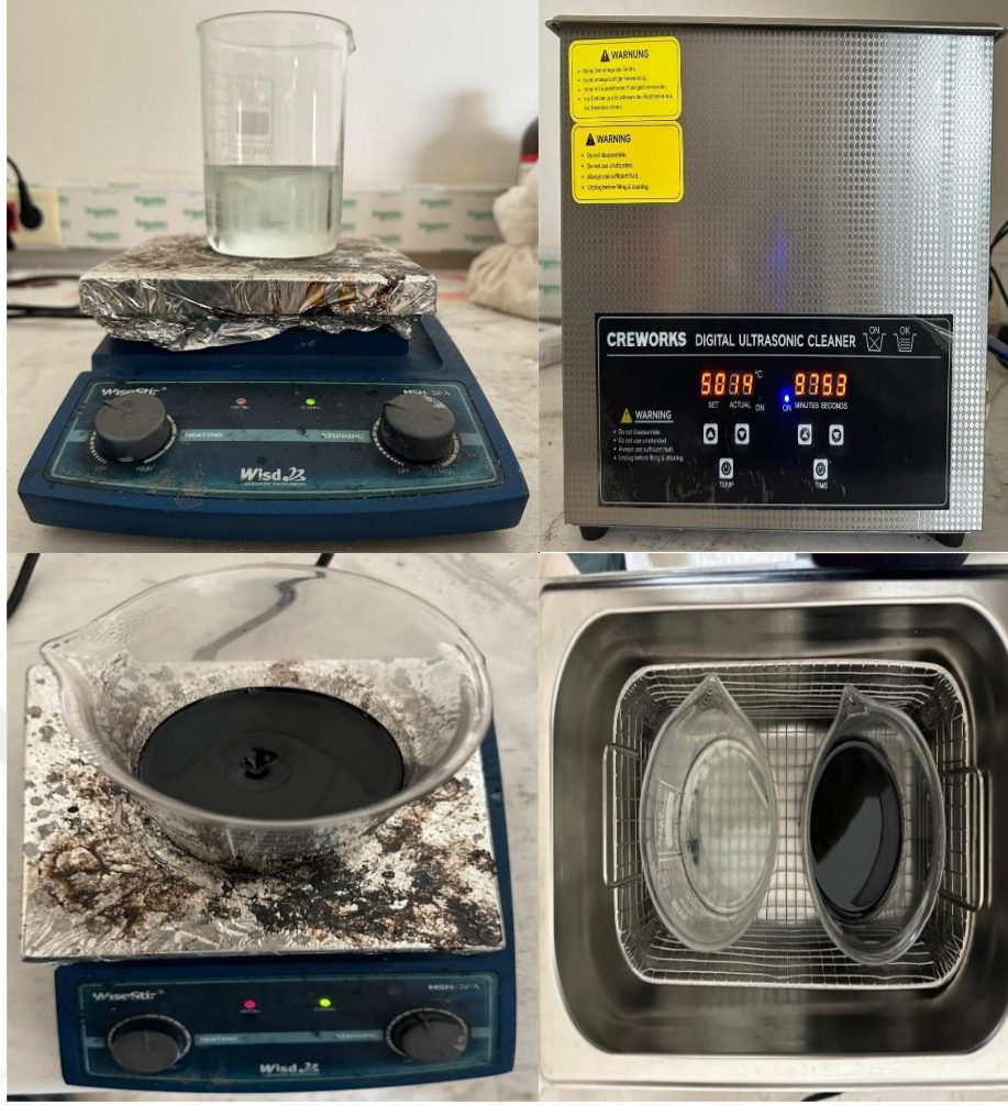
Şekil 3. 5. ARC 152 epoksi reçinesiyle CNF ve CNT tozlarının karıştırılması
