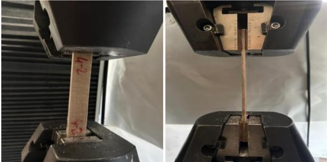
Şekil 3. 11. Dördüncü dizilime ait çekme testi görseli
