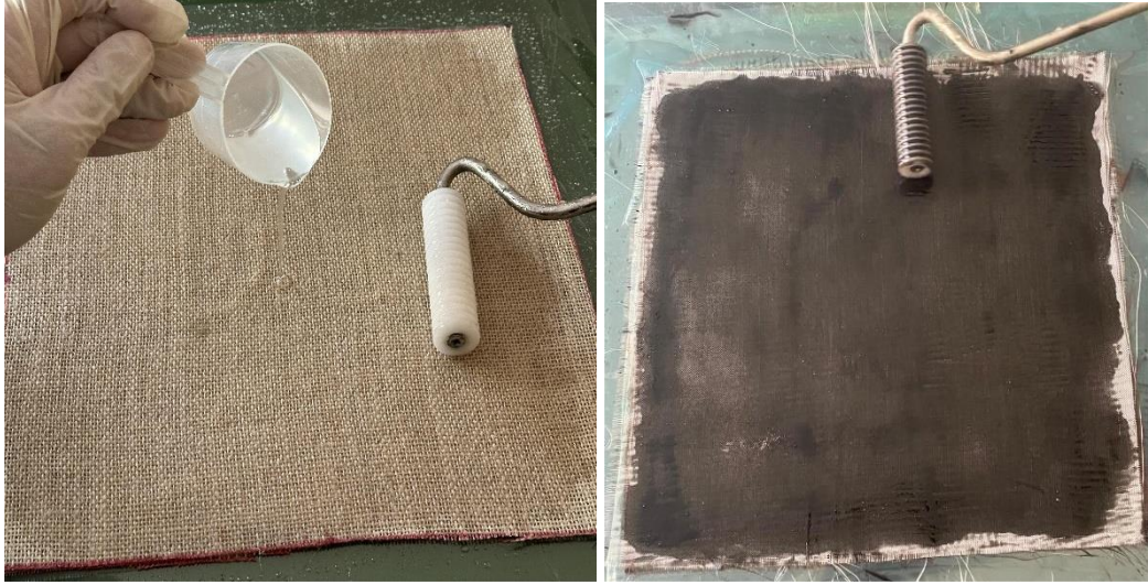
Şekil 3. 6. El yatırma tekniği ile toz karışımı olmayan ve toz karışımlı kompozit plakaların üretilmesi
