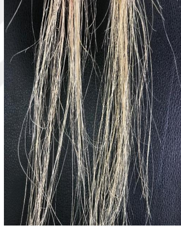
Şekil 4.3. Biyolojik yöntem ile üretilmiş iplik formu
