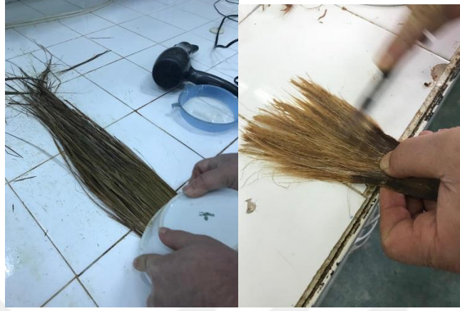
Şekil 4.7. Kör bıçak ve porselen tabak ile sıyırma işlemi
