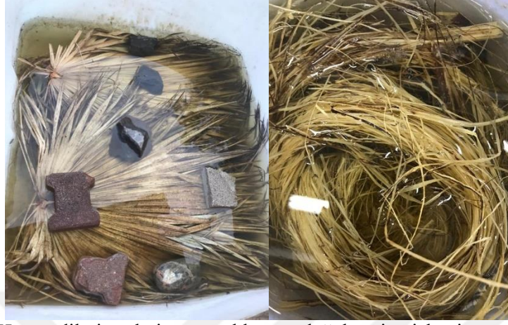
Şekil 4.2. Hasat edilmiş palmiye yapraklarının doğal retting işlemi
