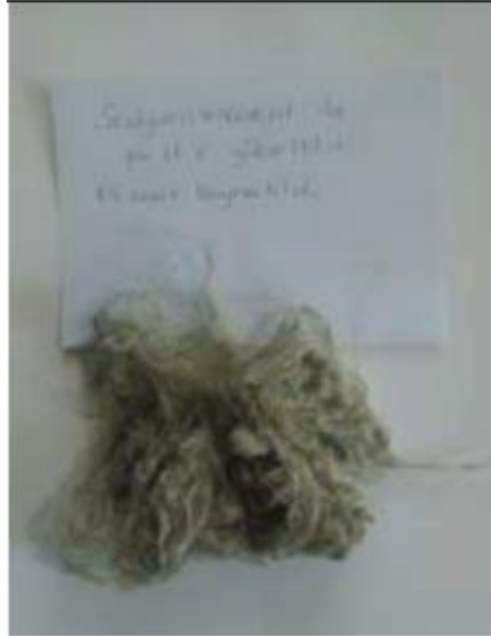
Şekil 2.3. Sodyumhidroksit ile kaynatılmış ısırgan otu lif görüntüsü
