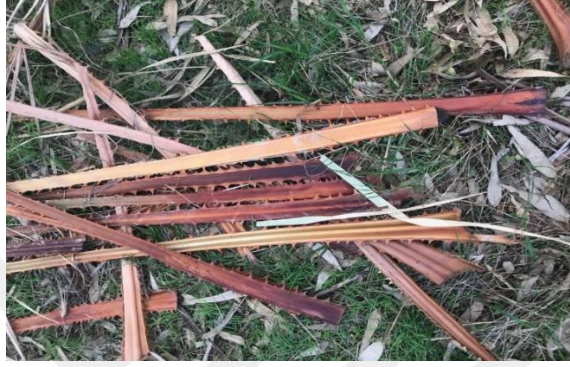
Şekil 4.11. Akdeniz palmiye türünün kınlarının mekanik parçalayıcılar vasıtası ile budanmış ve ayrılmış formu
