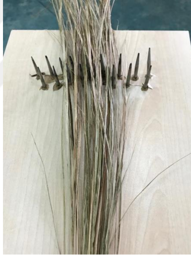
Şekil 4.6. Hasat edilmiş palmiye yapraklarının mekanik yöntemlerle taranma işlemi
