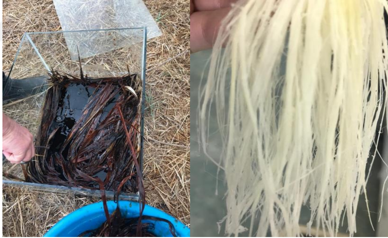
Şekil 4.5. Hasat edilmiş palmye yapraklarının alkali retting işlemi ve üretilen iplik formu
