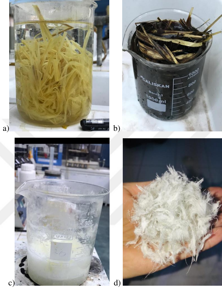
Şekil 4.9. a.) Lignoselülozik yapının bozulması b.) Zambak giderimi ve termal parçalama c.) Polisakkarit giderimi ve ağartma d.) Palmiye bitki atığından üretilmiş pamuk formu
