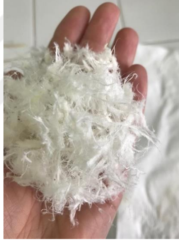
Şekil 4.16. Palmiye saplarının alkali ve ağartma işlemleri sonucunda üretilen hidrofil pamuk
