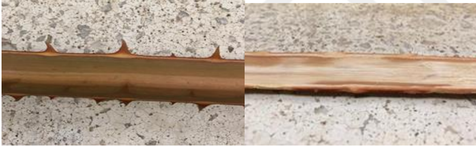
Şekil 4.12. Budanma sonrası ön işlem görmemiş palmiye sapı ve retting işlemi için dikenleri alınmış, sıyrılmış palmiye sapı
