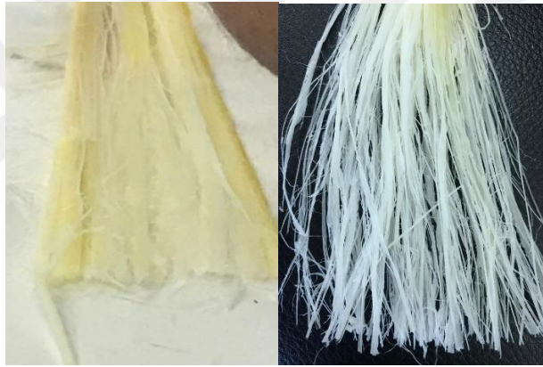
Şekil 4.14. Retting işleminden çıkarılan palmiye kınlarının sert bir cisimle baskılanması ve taranması sonucu elde edilen iplik formu
