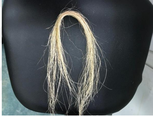
Şekil 4.8. Palmiye yaprağından mekanik yöntemlerle üretilmiş iplik formu
