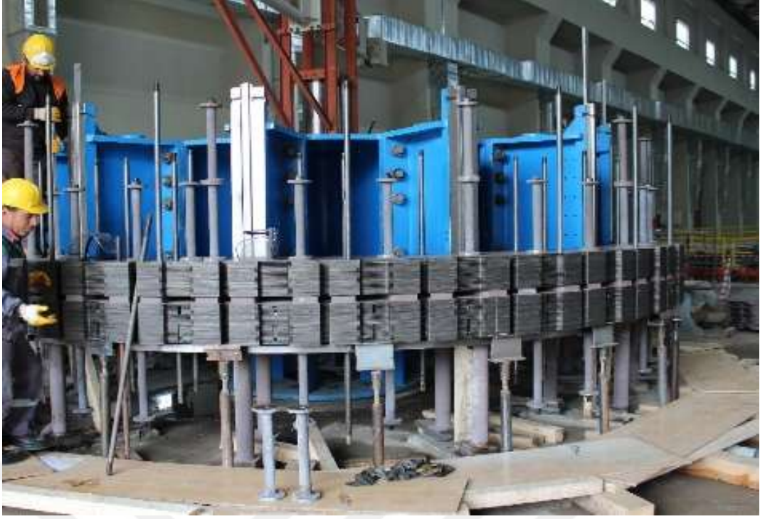
Şekil.19 Rotor laminasyon sacları ve imalat aşaması
