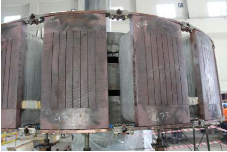
Şekil. 20 Manyetik kutup montajı ve kutup ayağı görüntüsü
