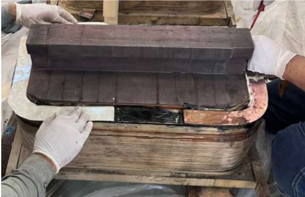
Şekil 24. Örnek bir dikdörtgen kesitli bakır iletkeni sahip rotor manyetik kutbu görüntüsü (Bağıştaş I HES)
