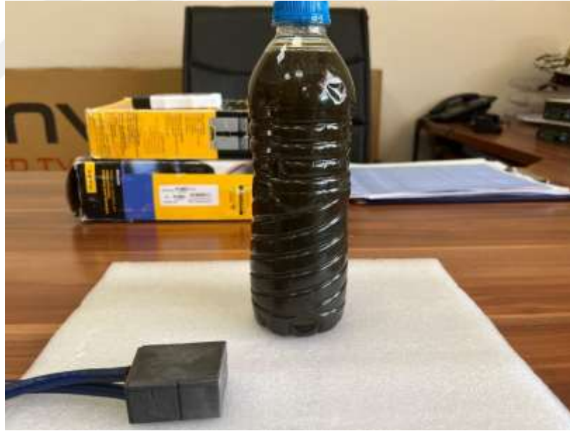
Şekil 49. Kirlendirilmiş olan türbin yağı
