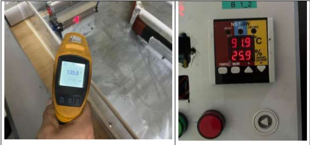
Şekil 53. Sargıların kurutulma işlemi esnasında alınan ölçümler
