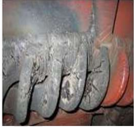
Şekil 30. Aşırı Akım kaynaklı Stator sargılar hasar görmüş bir generatör (Nugroho, Widiastuti, & Ary, 2017)
