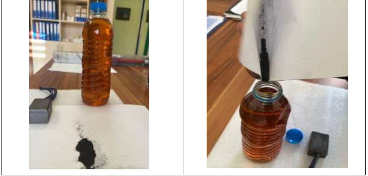
Şekil 48. Türbin yağı ve kömür tozu karışımının hazırlanma süreci
