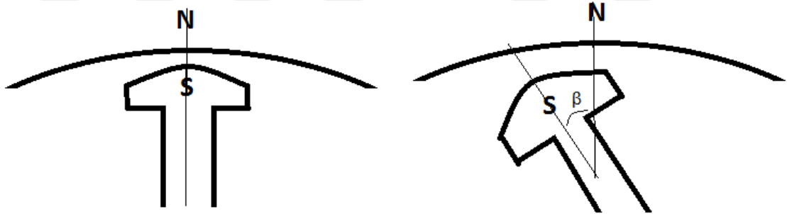
Şekil 3.21. Senkron motorun iki farklı mil momenti için rotor ve stator konumları ve yük açısı
