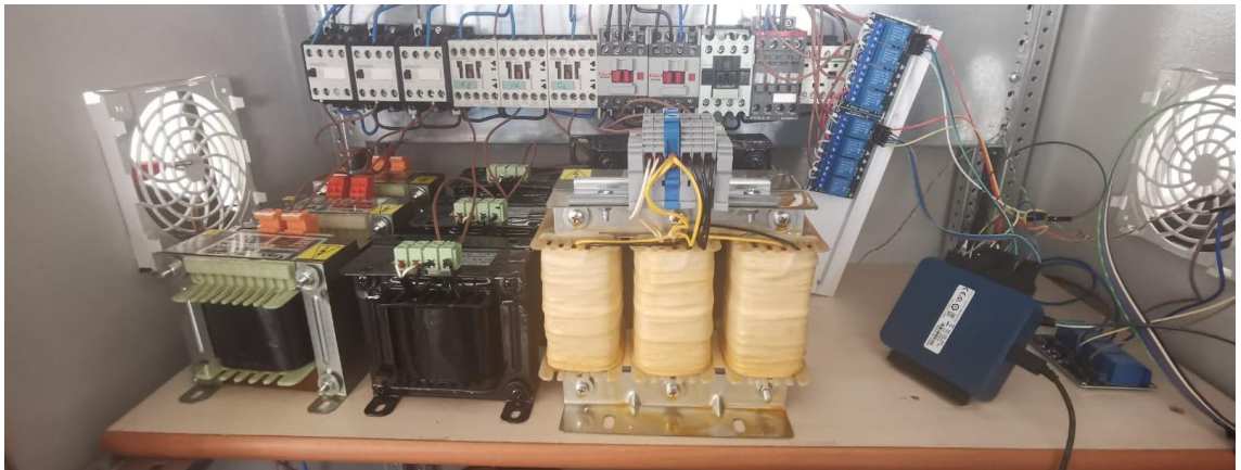
Şekil 4.25. Deneysel çalışmalarda kullanılan bobin yüklerinin ve ilgili donanımın görünümü
