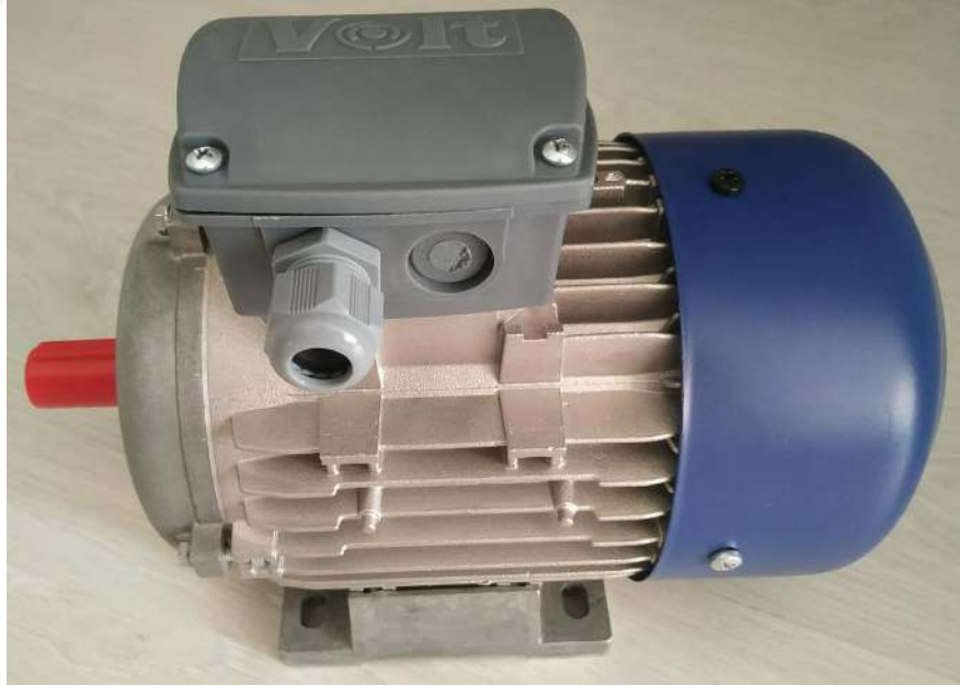
Şekil 4.8. Montajı tamamlanan motor
