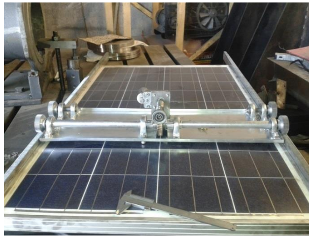
Şekil 3.11 Temizleme sistemi mekanik görünümü.
