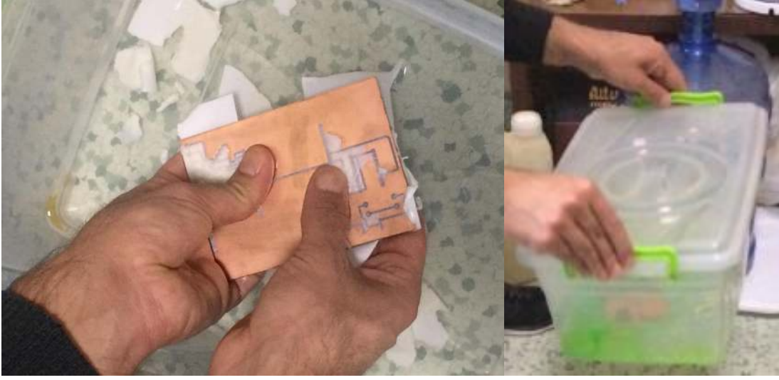
Şekil 3.18 Baskı devre çıkarma aşaması.
