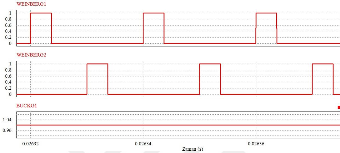
Şekil 3.45. Önerilen güç dönüştürücünün anahtarlama sinyalleri (Weinberg kipi, V_i = 40 V için)
