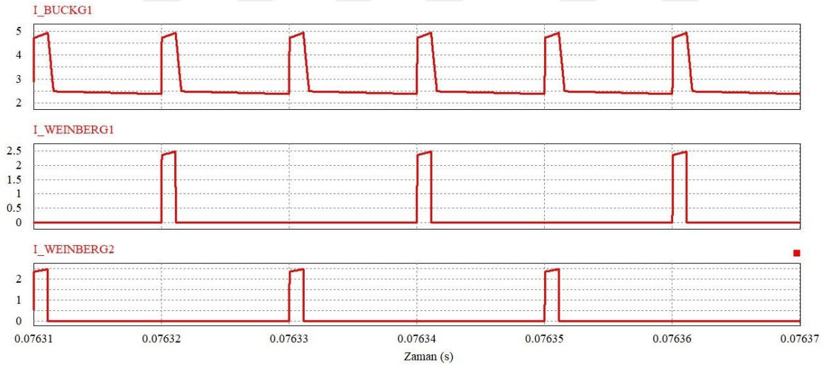
Şekil 3.42. Önerilen güç dönüştürücünün yükü değiştirildikten sonra anahtarları üzerinden akan akımlar (Weinberg kipi, V_i = 45 V için)
