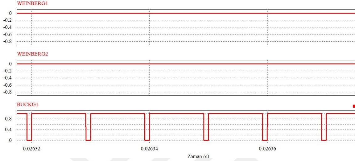
Şekil 3.15. Önerilen güç dönüştürücünün anahtarlama sinyalleri (Buck kipi, V_i = 60 V için)
