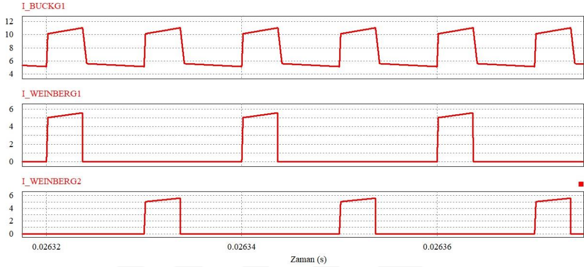
Şekil 3.47. Önerilen güç dönüştürücünün anahtarları üzerinden akan akımlar (Weinberg kipi, V_i = 40 V için)
