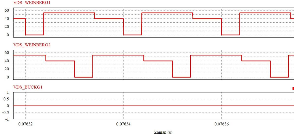
Şekil 3.59. Önerilen güç dönüştürücünün anahtar terminalleri arasındaki gerilimler (Kipler arası geçiş durumu-Weinberg kipi)
