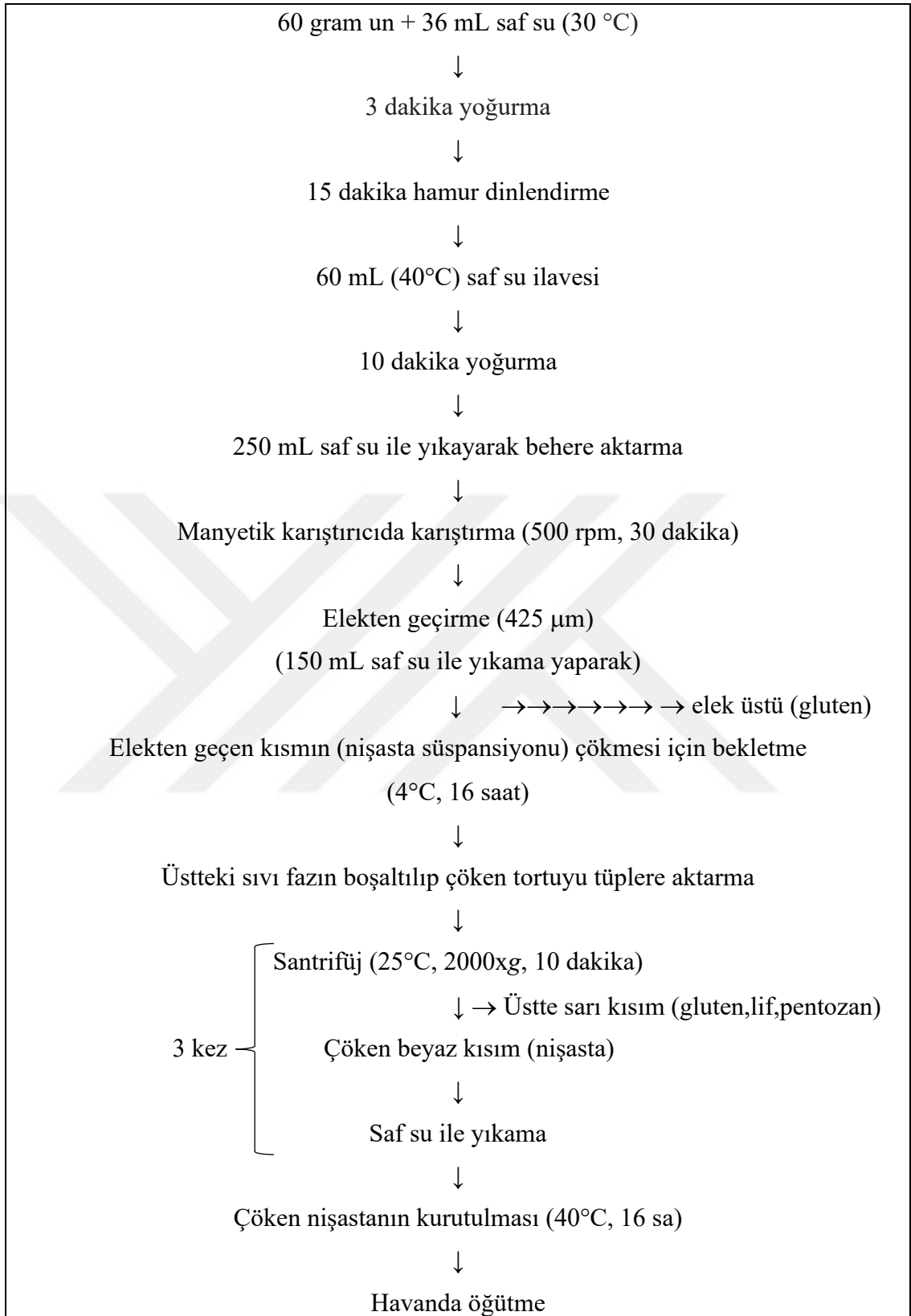
Şekil 3.1. Nişasta izolasyonu akım şeması
