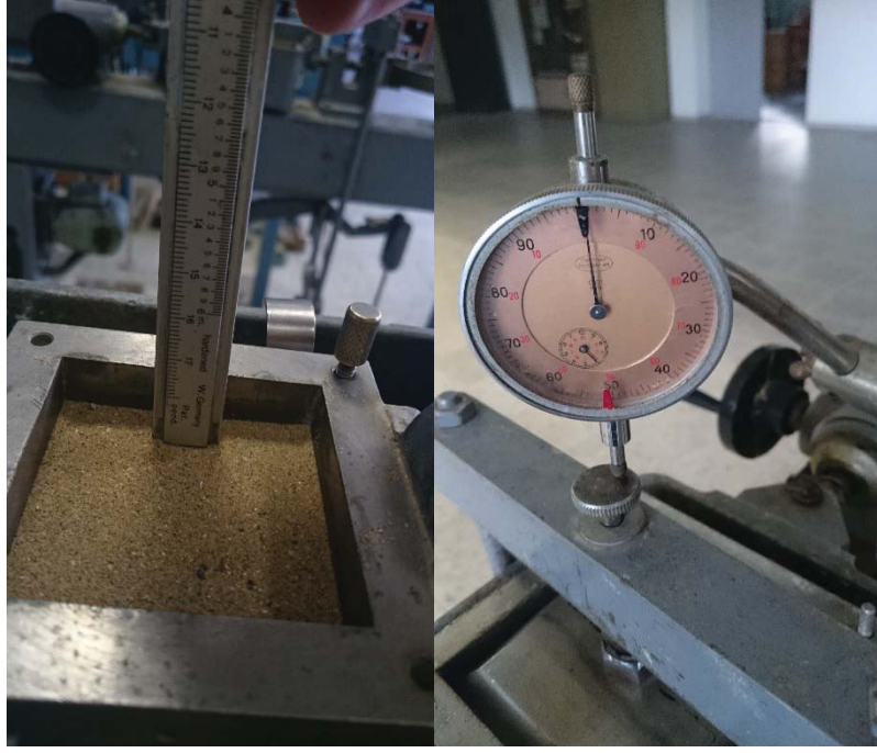
Şekil B.4 : Numune kalınlığının kontrolü ve düşey deformasyonunun kalibrasyonu.
