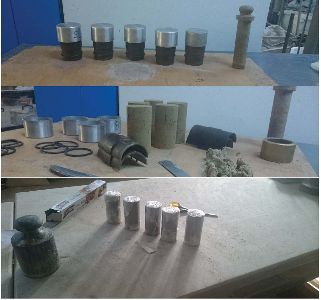
Şekil B.6 : Serbest basınç numunelerinin kalıpta bekletilmesi, kalıptan çıkarılması ve nem kaybına karşı korunması.
