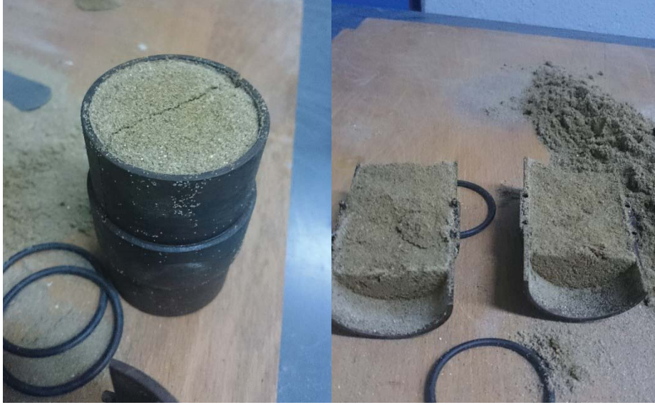
Şekil 4.39 : Kalıp çıkarma süresinin kısa tutulması durumunda numunenin kırılması.
