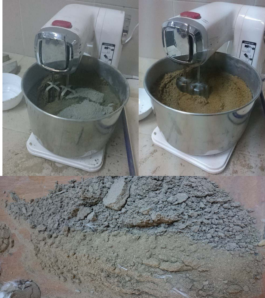
Şekil B.5 : Farklı çimento oranlarına sahip karışımların hazırlanması ve priz aldıktan sonraki görünüşleri.
