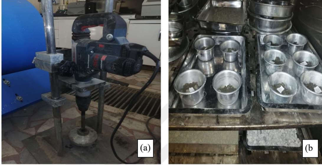
Şekil 5.4: SSB karışımların optimum su muhtevelarının belirlenmesi (a) Titreşimli kompaktör (b) Su muhtevası numuneleri
