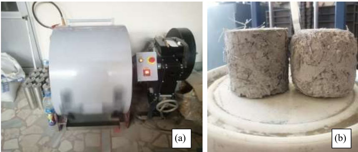
Şekil 5.9: Cantabro aşınma kaybı deneyi (a) Los Angeles cihazı (b) Deney öncesi ve sonrasında numune örneği
