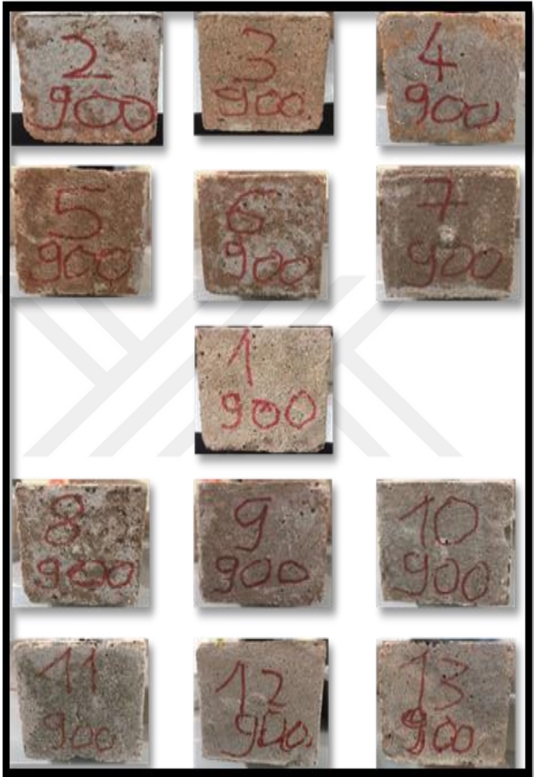
Şekil 4.16. Yüksek sıcaklığa maruz kalan geopolimer numunelerin görsel incelenmesi (900°C)
