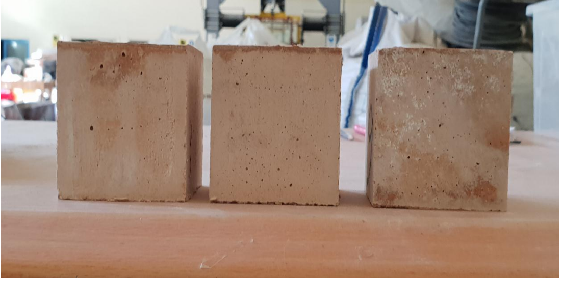
Şekil 3.22. 71 \pm 1.5 mm küp numuneler
