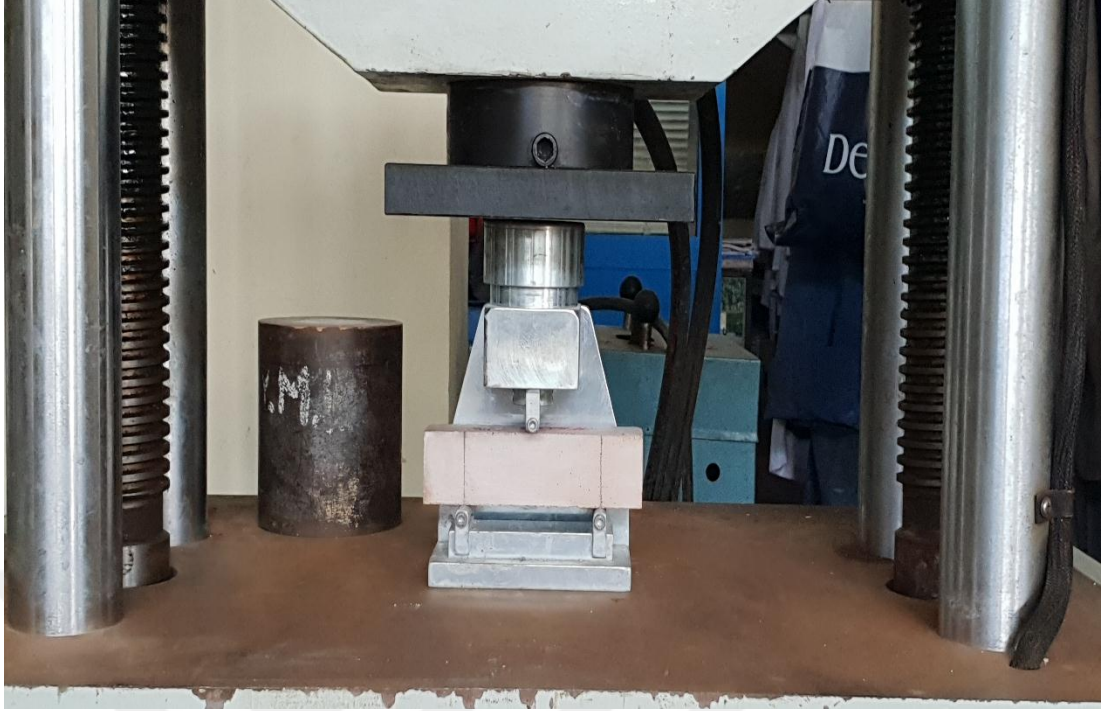
Şekil 3.18. Eğilme dayanımı testinin prizma numulere uygulanması
