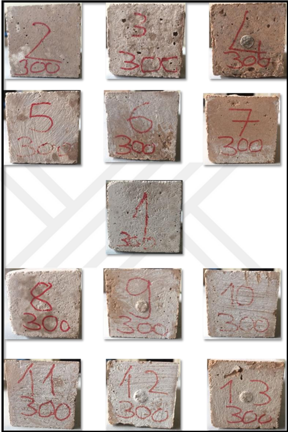
Şekil 4.14. Yüksek sıcaklığa maruz kalan geopolimer numunelerin görsel incelenmesi (300°C)
