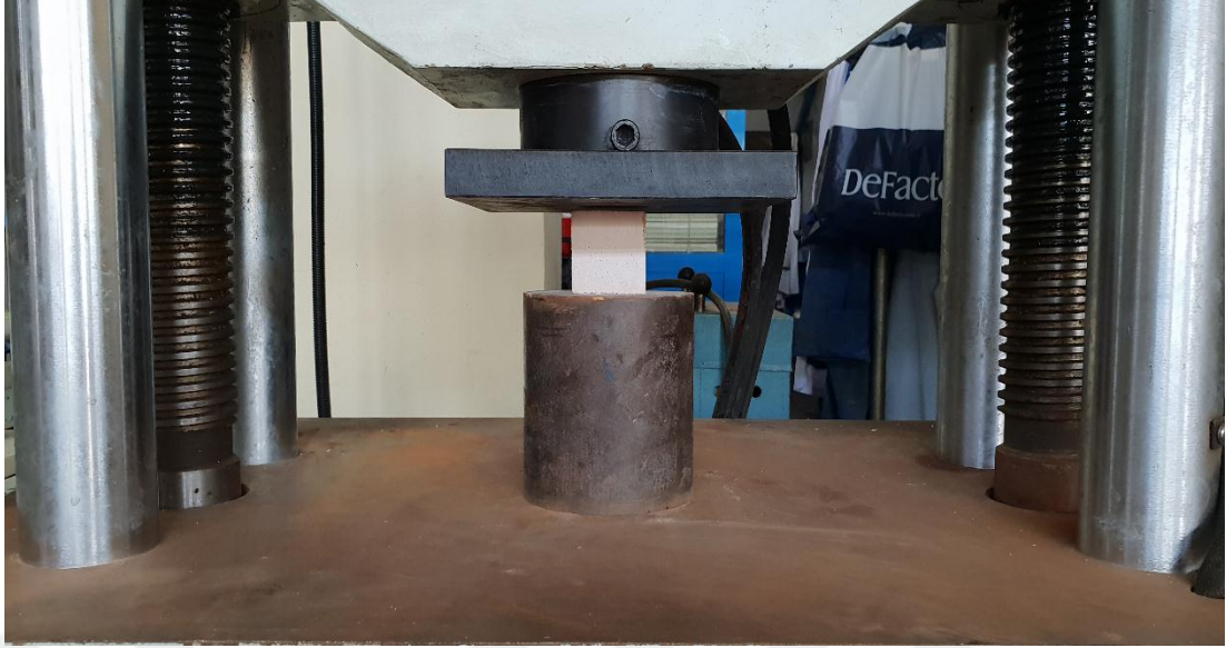
Şekil 3.17. Basınç dayanımı testinin küp numunelerde uygulanması
