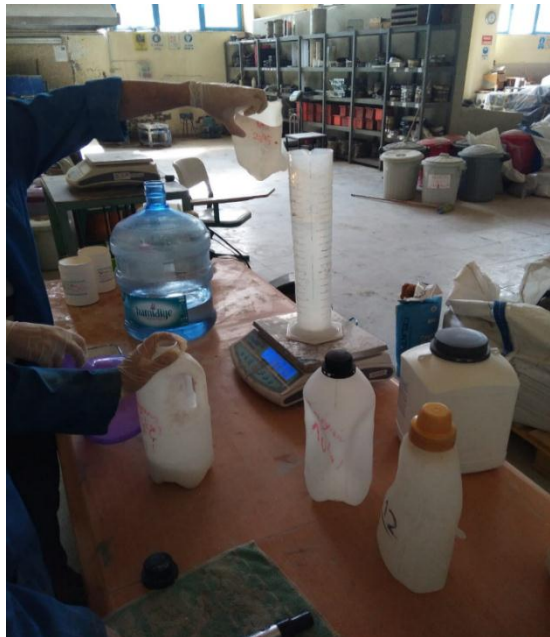
Şekil 3.11. Sodyum hidroksit kimyasal çözeltisinin hazırlanması
