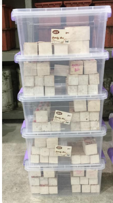
Şekil 3.34. Numunelerin plastik saklama kutularına konulması
