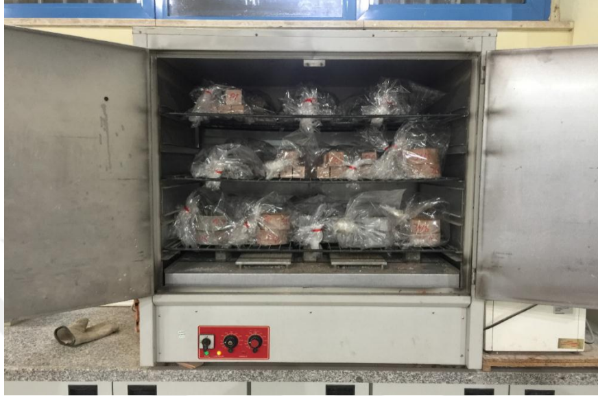
Şekil 3.33. Yanmaz fırın poşetli numunelerinin fırına konulması
