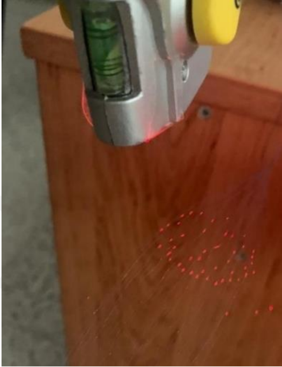
Şekil 2.3 Lazer ışını ile filamentlerin kesişimi
