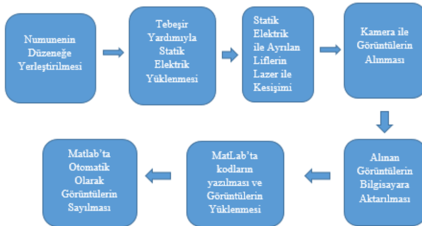
Şekil 2.9 Görüntü analizi ile sayma yöntemi akış şeması
