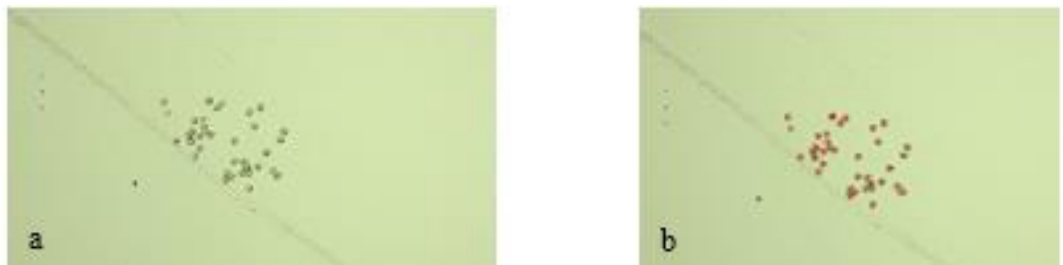
Şekil 3.17 83 dtex f36 poliester enine kesit görüntüleri (a. Enine kesit mikroskop görüntüsü b. Mikroskop görüntüsünün sayılması)
