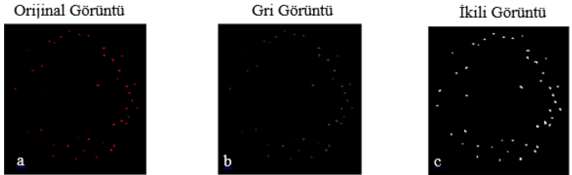
Şekil 3.2 140 dtex f48 polipropilen ipliği görüntü analizi çıktısı (a. RGB b. Gri seviye görüntü c. İkili görüntü)
