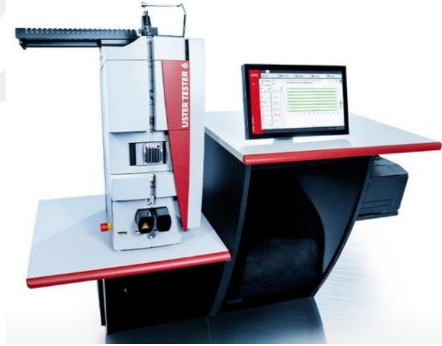
Şekil 1.18 Uster filament düzgünsüzlük cihazı (Uster, 2022)
