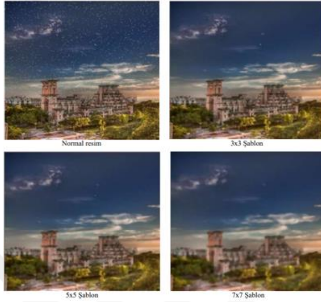
Şekil 1.32 Farklı boyutlarda şablon ile medyan filtre uygulanması (Çayiroğlu, b.t.)
