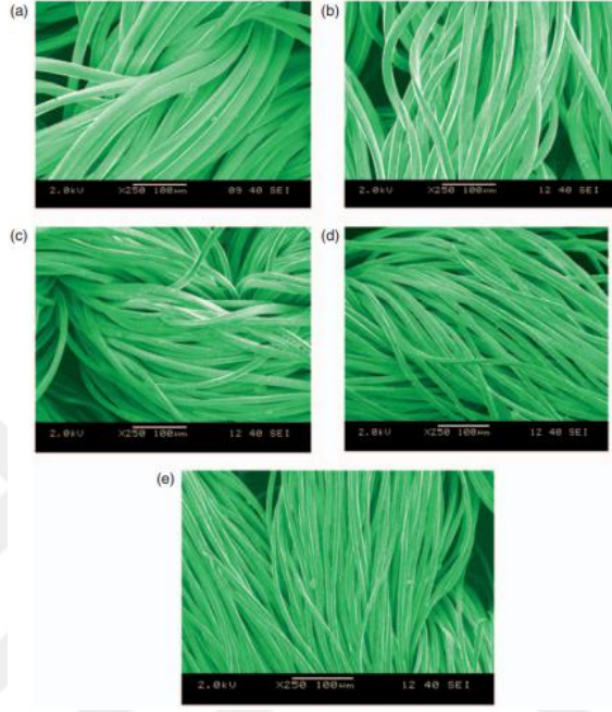
Şekil 1.52 Poliester örme kumaşların elektron mikroskop görüntüleri (a. 150 denye 34 filament b. 150 denye 48 filament c. 150 denye 108 filament d. 150 denye 144 filament e. 150 denye 288 filament) (Sampath vd., 2011)
