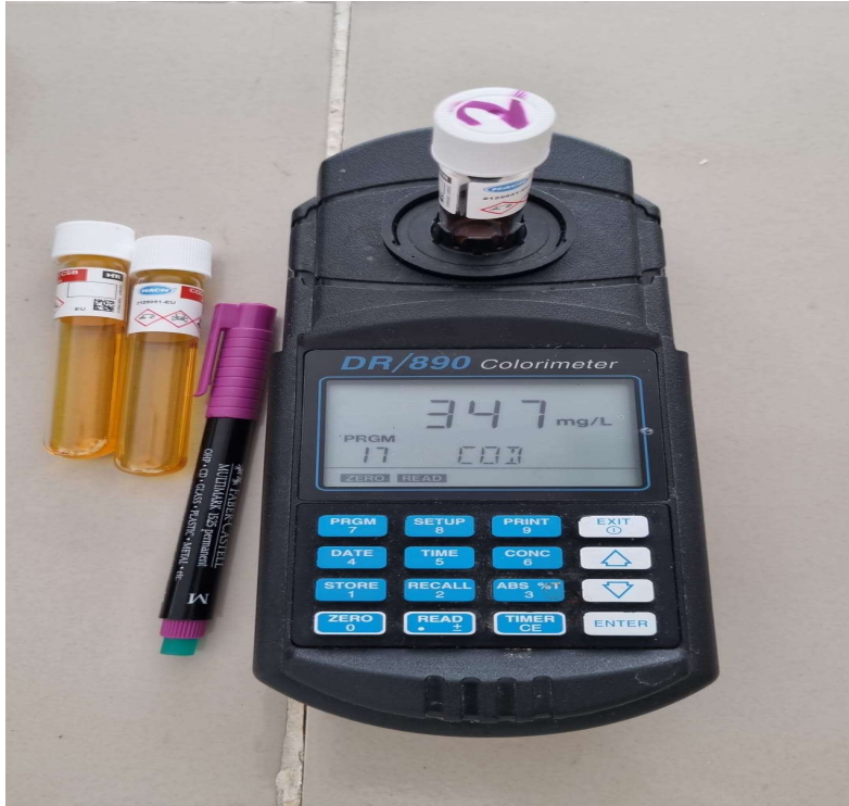
Resim 2.6. DR/890 Kolorimetrik KOİ cihazı (Orijinal)
