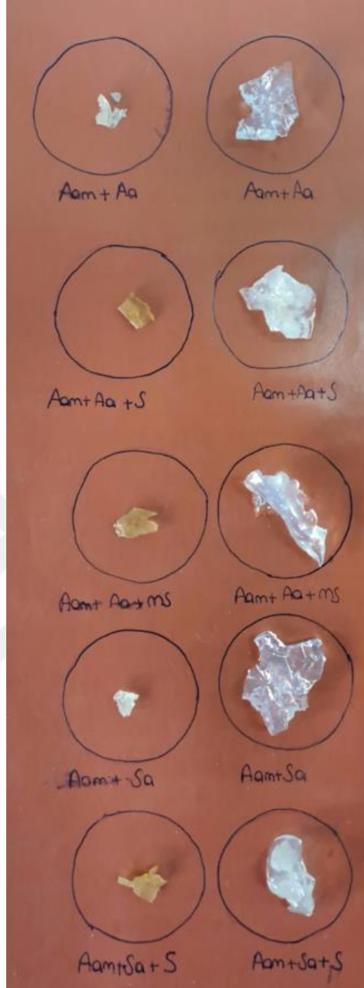
Şekil 4.21. Hidrojellerin kuru ve şişmiş halleri
