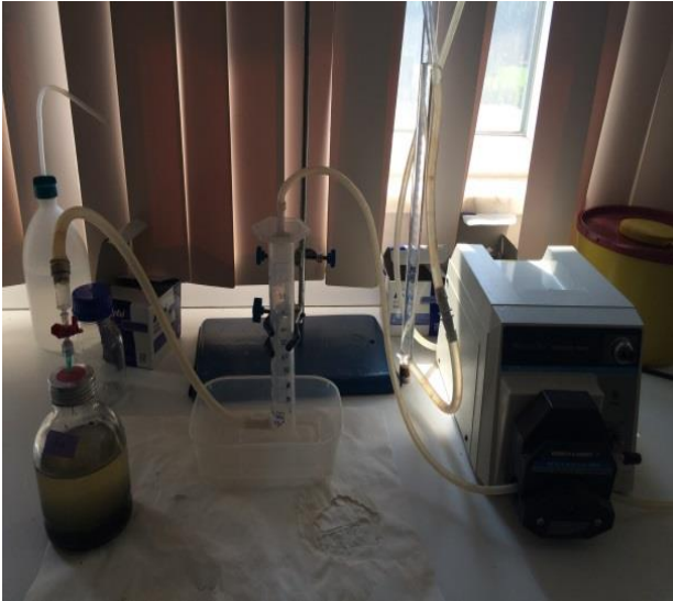
Şekil 3.4. Biyogaz miktarı ölçüm düzeneği
