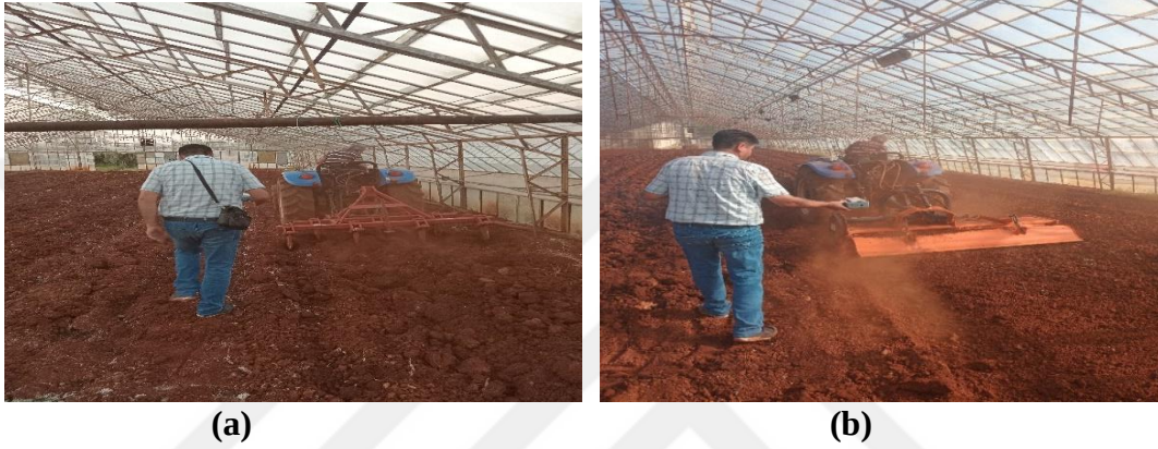
Şekil 3.6. Toprak işleme sırasındaki (a-çizel, b-toprak frezesi) ölçüm görüntüleri
