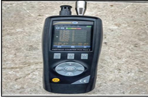
Şekil 3.5. Partikül ölçüm cihazı (PCE)
