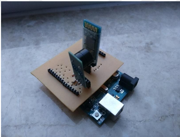
Şekil 3.2.18. Araç için geliştirilen baskı devrenin montajlı hali.
