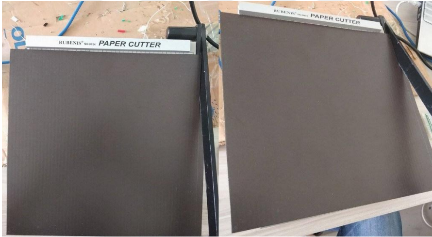
Şekil 3.2.7. Kullanılan tabaka mıknatısların giyotin ile şeritler halinde kesimi.
