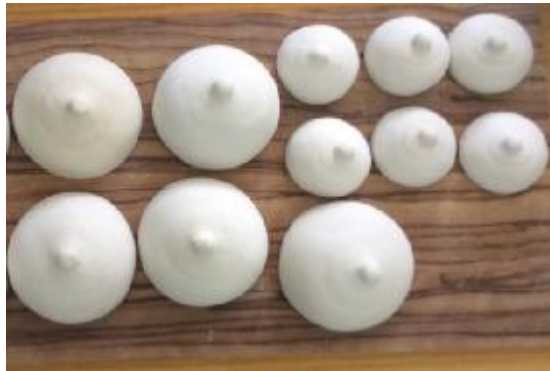
Şekil 2. Porselen çamuru ile döküm yapılarak hazırlanmış formlar
