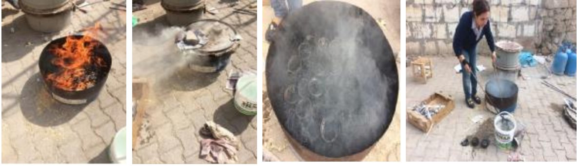
Şekil 3. Sırlı örneklerin pişirimi ve redüksiyon işlemi
