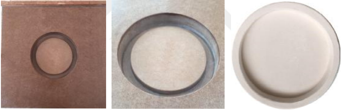
Şekil 1. Sır araştırmalarında kullanılan kalıp ve deney tableti
