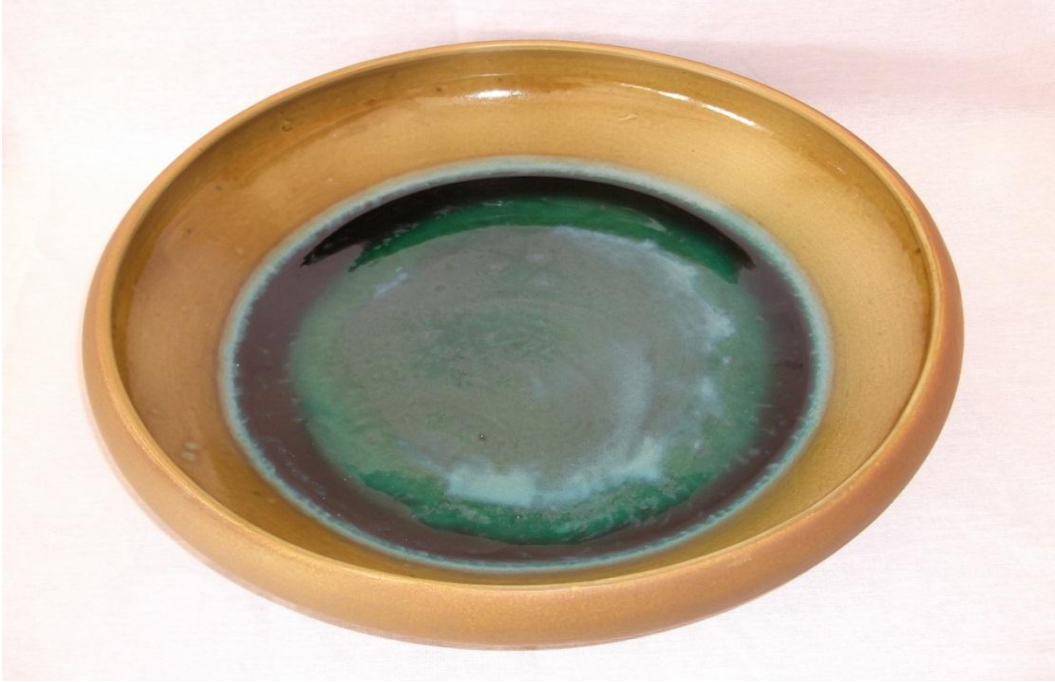
Resim 51. Beyaz earthenware bünye üzerine SA-S3 no'lu sır uygulaması (iç kısmı firuze sırlı), 1060 °C, 2014.
