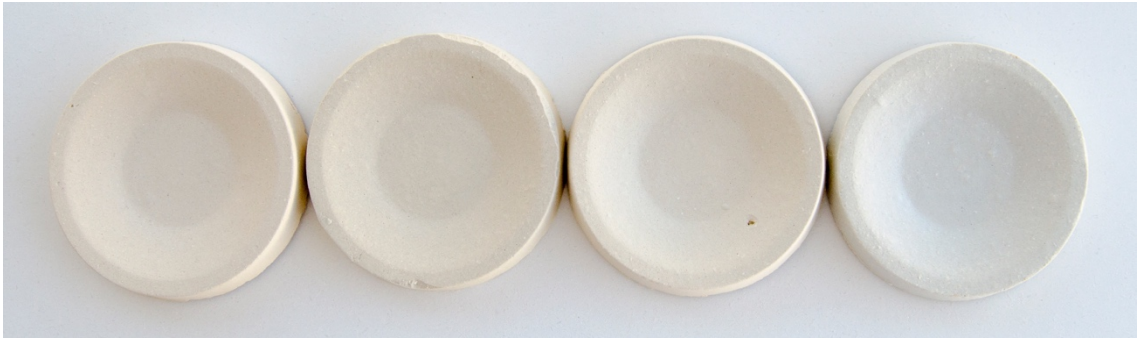
Görsel 5.3. Çinko oksit katkılı döküm çamuru ile hazırlanan deneme plakalarının pişirim sonrası görünümleri.
