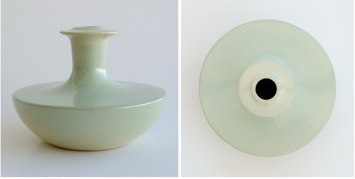
Görsel 5.5. Seçilen renklendirilmiş sır reçetesinin (ZN.Tİ.ZR.34 +%3 CuO) vazo formunun yan ve üst görünümü.
