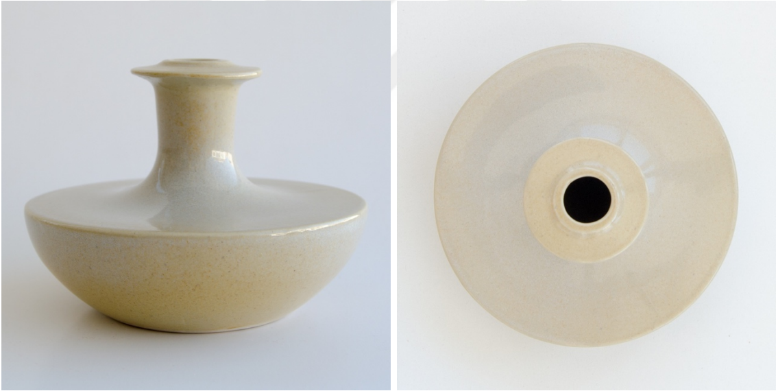
Görsel 5.6. Seçilen renklendirilmiş sır reçetesinin (ZN.Tİ.ZR.34 +%1 Fe 2 O 3 ) vazo formunun yan ve üst görünümü.
