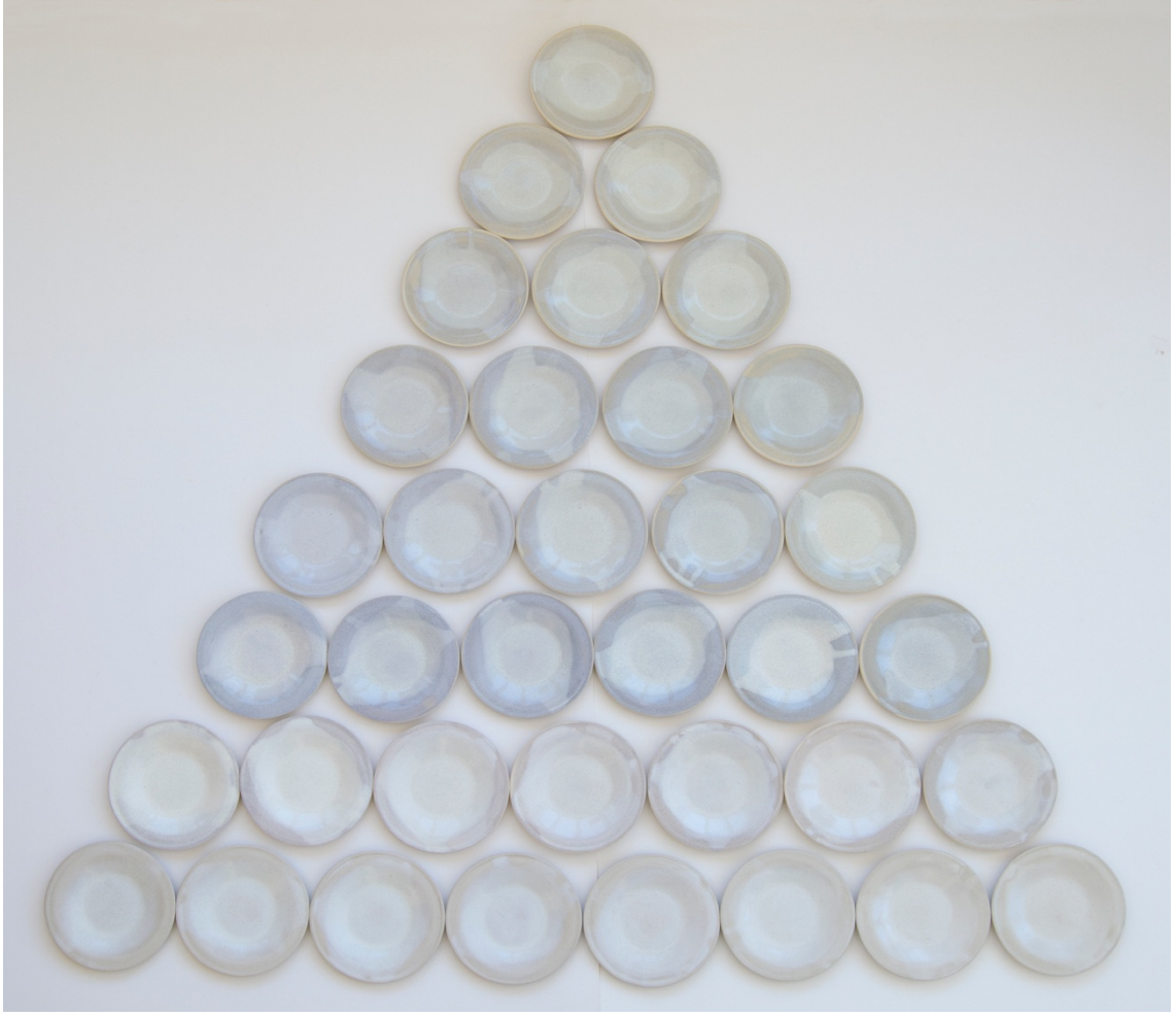
Görsel 5.18. Şeffaf seramik sırına Çinko oksit, Titanyum oksit ve Zirkon oksit ilave edilerek 1200 °C’de pişirilmiş deney plakaları.
