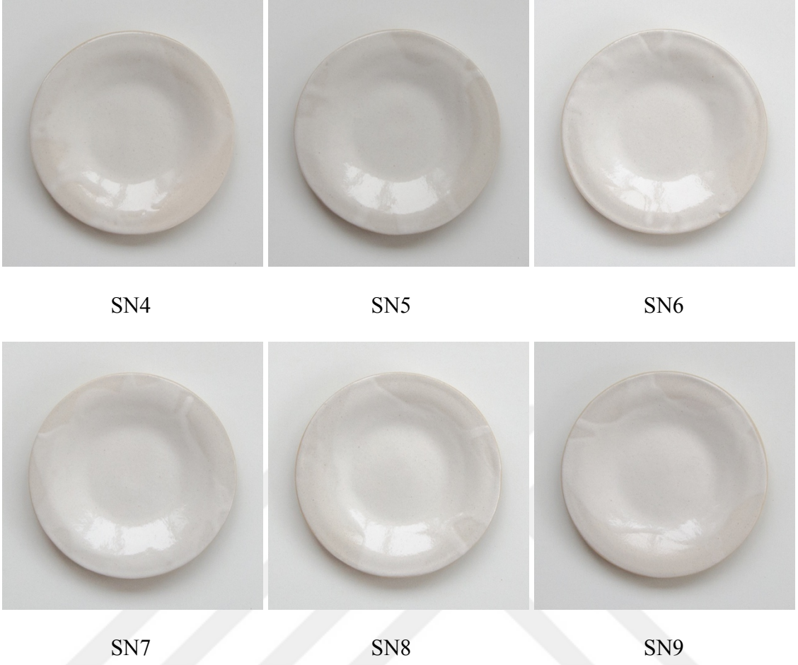
Görsel 5.13. Şeffaf seramik sırına Kalay oksit ilave edilerek 1200 °C’de pişirilmiş deney plakaları.
