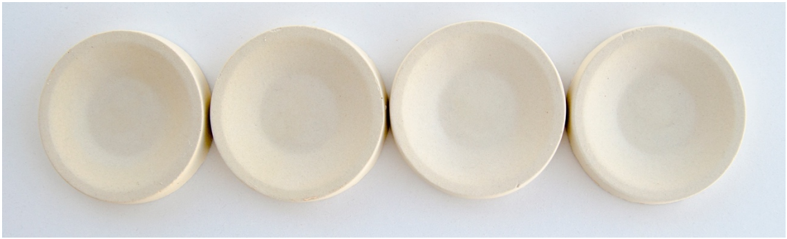
Görsel 5.9. Zirkon oksit katkılı döküm çamuru ile hazırlanan deneme plakalarının pişirim sonrası görünümleri.
