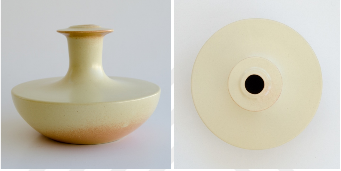
Görsel 5.1. Seçilen renklendirilmiş sır reçetesinin (SN.CA.BA.29 +%1 Fe_2O_3 ) vazo formunun yan ve üst görünümü.
