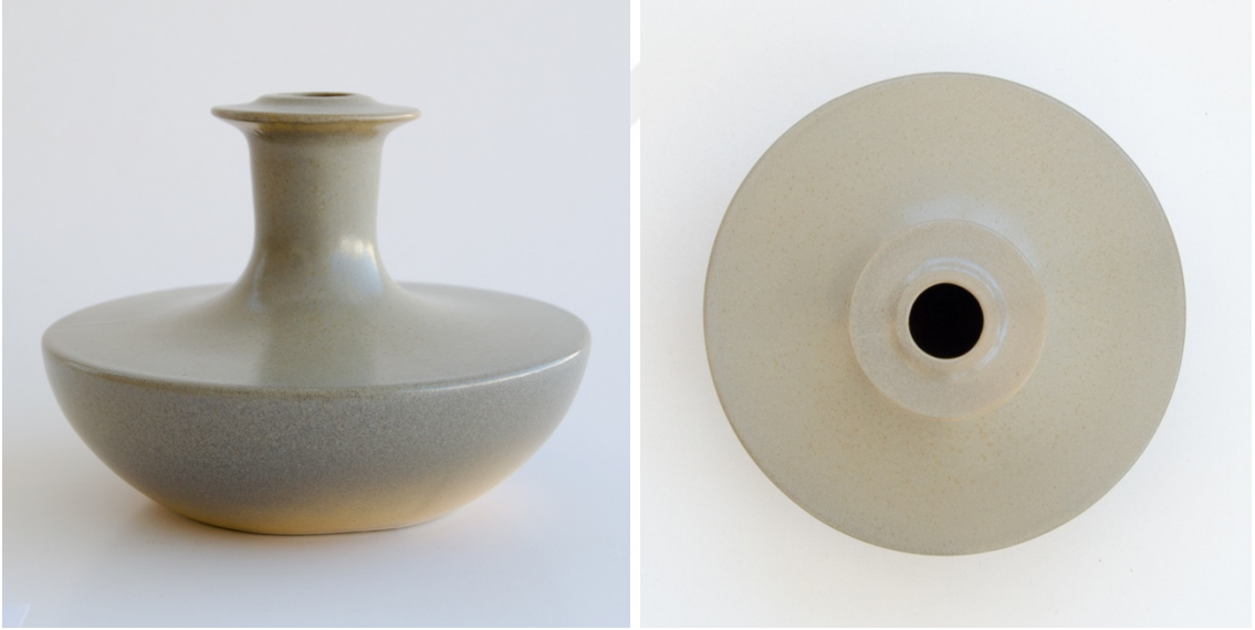
Görsel 5.12. Seçilen renklendirilmiş sır reçetesinin ( \text{ZN9} + \%3 \text{ Fe}_2\text{O}_3 ) vazo formunun yan ve üst görünümü.
