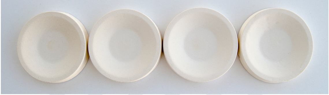
Görsel 5.1. Baryum oksit katkılı döküm çamuru ile hazırlanan deneme plakalarının pişirim sonrası görüntüleri.
