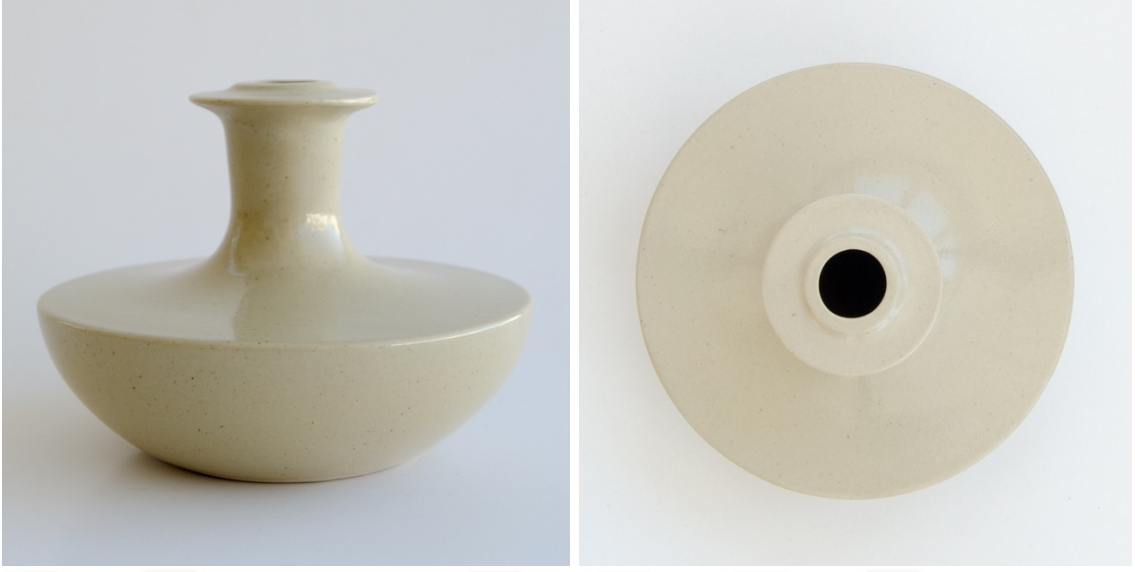
Görsel 5.17. Seçilen renklendirilmiş sır reçetesinin ( ZR6 + \%1 Fe_2O_3 ) vazo formunun yan ve üst görünümü.
