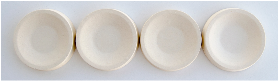
Görsel 5.5. Kalay oksit katkılı döküm çamuru ile hazırlanan deneme plakalarının pişirim sonrası görünümleri.
