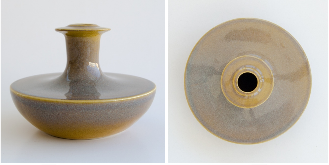
Görsel 5.15. Seçilen renklendirilmiş sır reçetesinin ( \text{ZN6} + \%3 \text{Fe}_2\text{O}_3 ) vazo formunun yan ve üst görünümü.
