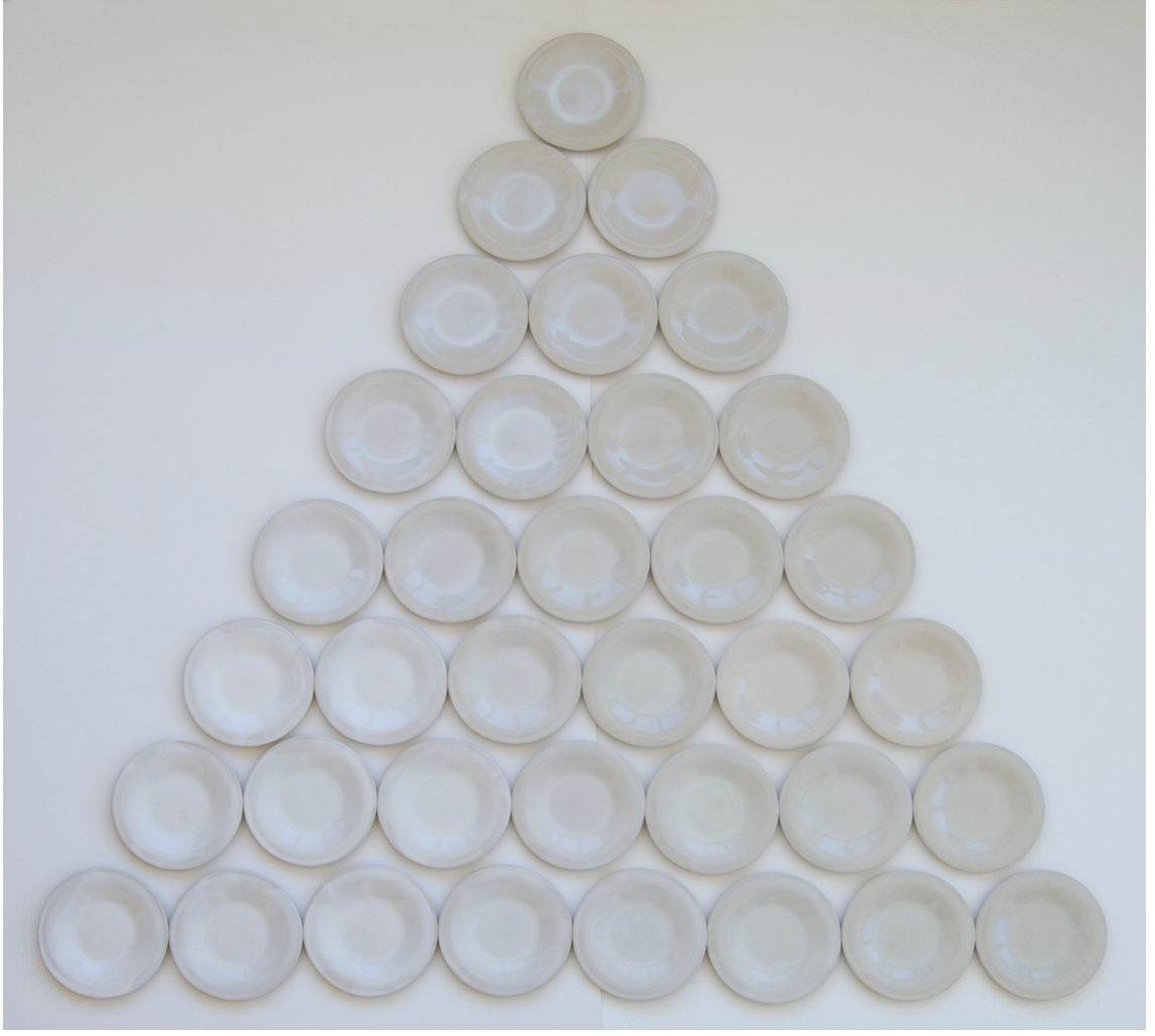
Görsel 5.20. Şeffaf seramik sırtına Kalay oksit, Kalsiyum oksit ve Baryum oksit ilave edilerek 1200 °C'de pişirilmiş deney plakaları.
