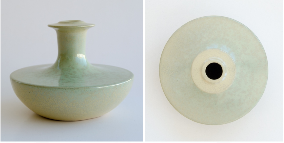
Görsel 5.11. Seçilen renklendirilmiş sır reçetesinin ( \text{ZN9} + \%3 \text{ CuO} ) vazo formunun yan ve üst görünümü.
