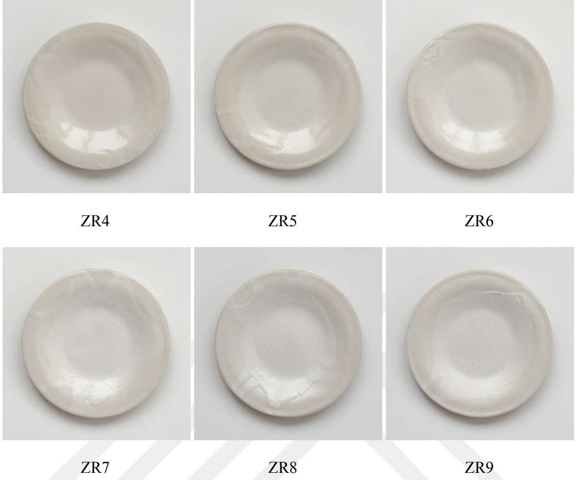
Görsel 5.16. Şeffaf seramik sırına Zirkon oksit ilave edilerek 1200 °C’de pişirilmiş deney plakaları.
