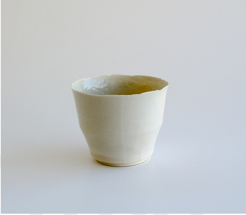
Görsel.5.4. Çinko oksit katkılı döküm çamuru ile hazırlanan yarısı şeffaf sırlı kase formu.
