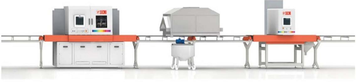
Şekil 23. Dijital yapıştırıcı seçeneği ile post-dekorasyon uygulama sırası veya DDG sisteminin doğal dijital bırakımı örneği
