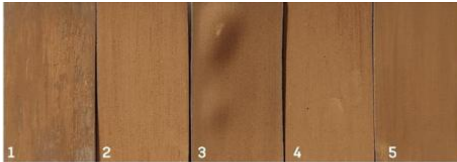
Resim 3.26. 2 gr bej pigment ile hazırlanan çözeltilerin uygulandığı tabletler. (1) 5ml Su + 2gr Bej Pigment, (2) 5ml Benzin + 2gr Bej Pigment, (3) 5ml Mazot + 2gr Bej Pigment, (4) 5ml Selülozik tiner + 2gr Bej Pigment, (5) 5ml Sentetik tiner + 2gr Bej Pigment, (Cihan Yavaş Görsel Galerisi)
