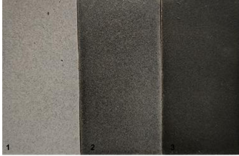
Resim 3.76. Tabletlerin fırın çıkışı görselleri-52 (1) 1gr Siyah pigment +parlak sır, (2) 3gr Siyah pigment + parlak sır, (3) 5gr Siyah pigment + parlak sır.(Cihan Yavaş Görsel Galerisi)
