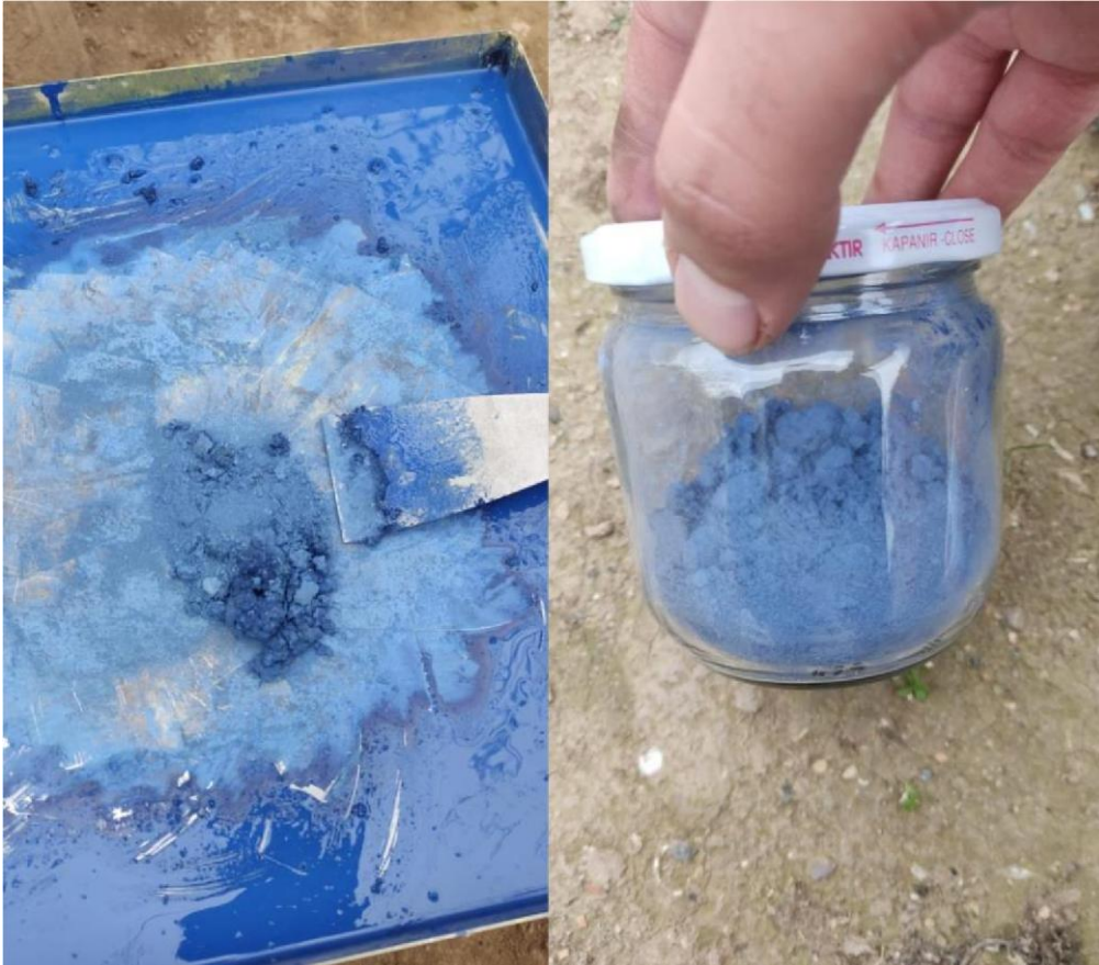
Resim 3.3. Buharlaşan solventten sonra geriye kalan pigment (Cihan Yavaş Görsel Galerisi)
