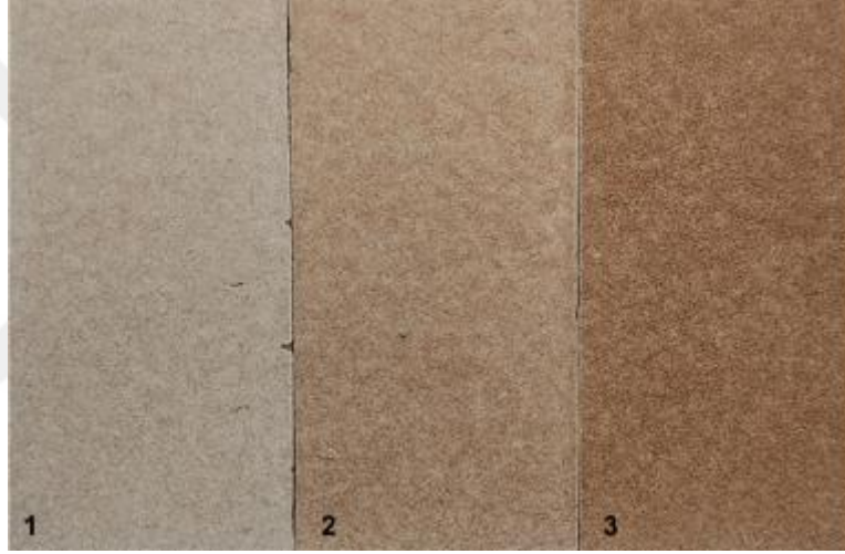
Resim 3.83. Tabletlerin fırın çıkışı görselleri-59 (1) 1gr kahverengi pigment +şugar sır, (2) 3gr kahverengi pigment + şugar sır, (3) 5gr kahverengi pigment + şugar sır.(Cihan Yavaş Görsel Galerisi)
