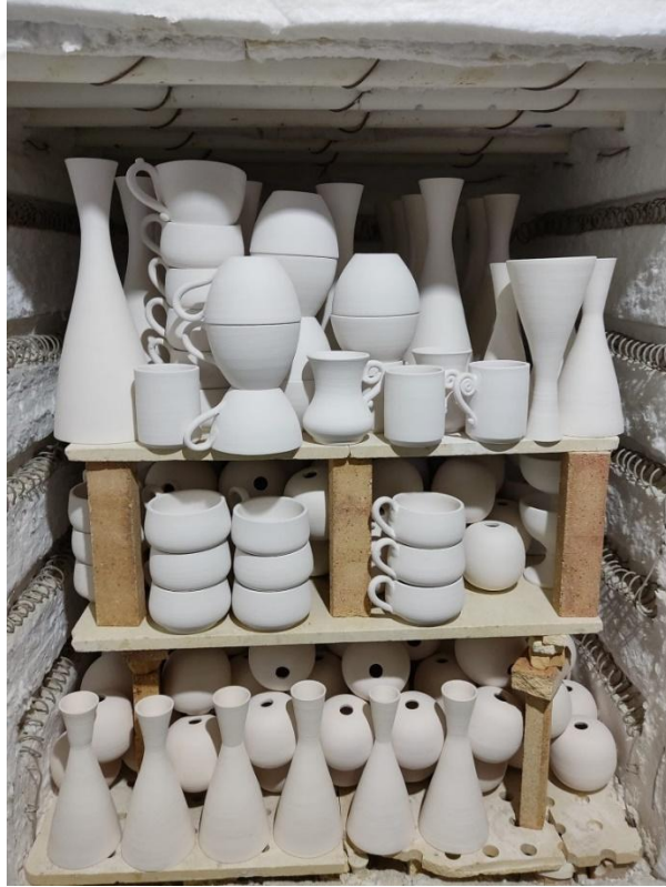
Resim 3.90. Stoneware çamurundan oluşturulan vazoların bisküvi pişirimleri. (Cihan Yavaş Görsel Galerisi)
