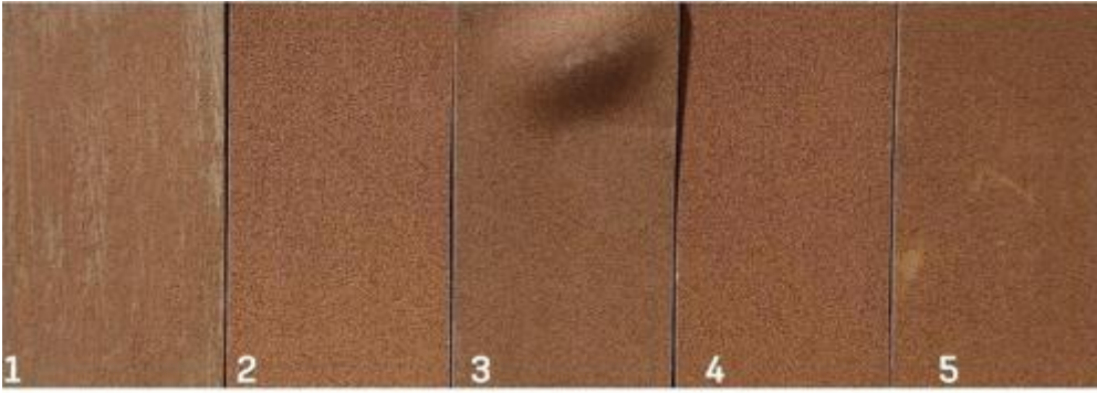
Resim 3.50. 2 gr bej rengi pigment ile hazırlanan çözeltilerin uygulandığı tabletler. (1) 5ml Su + 2gr Bej Pigment, (2) 5ml Benzin + 2gr Bej Pigment, (3) 5ml Mazot + 2gr Bej Pigment, (4) 5ml Selülozik tiner + 2gr Bej Pigment, (5) 5ml Sentetik tiner + 2gr Bej Pigment, (Cihan Yavaş Görsel Galerisi)
