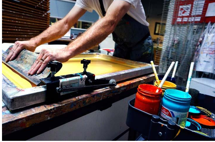
Şekil 2: Düz elek baskı [7]
