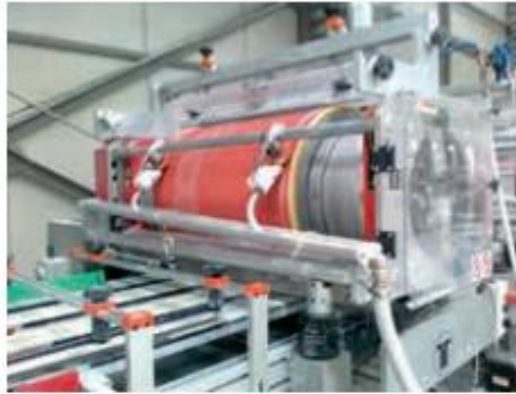
Şekil 3: Döner Elek Baskı Rotocolor [8]
