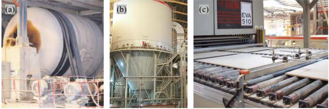
Görsel 3.1. a) Bilyeli değirmen, b) Püskürtmeli kurutucu, c) Sacmi marka dikey kurutucu [11]
