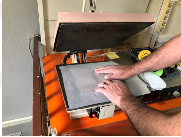
4. Sıcak baskı sırasında polimerin degrade olmaması için yağlı kağıt yerleştirilmesi
