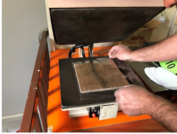
3. Numune üzerine polimer malzemenin (Surlyn® 1706) yerleştirilmesi
