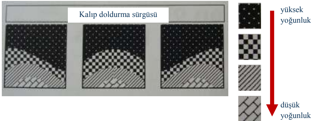
Şekil 2.2. Preslenmiş üründe yoğunluk dağılımı (kesit alanı) (Werr 2002)
