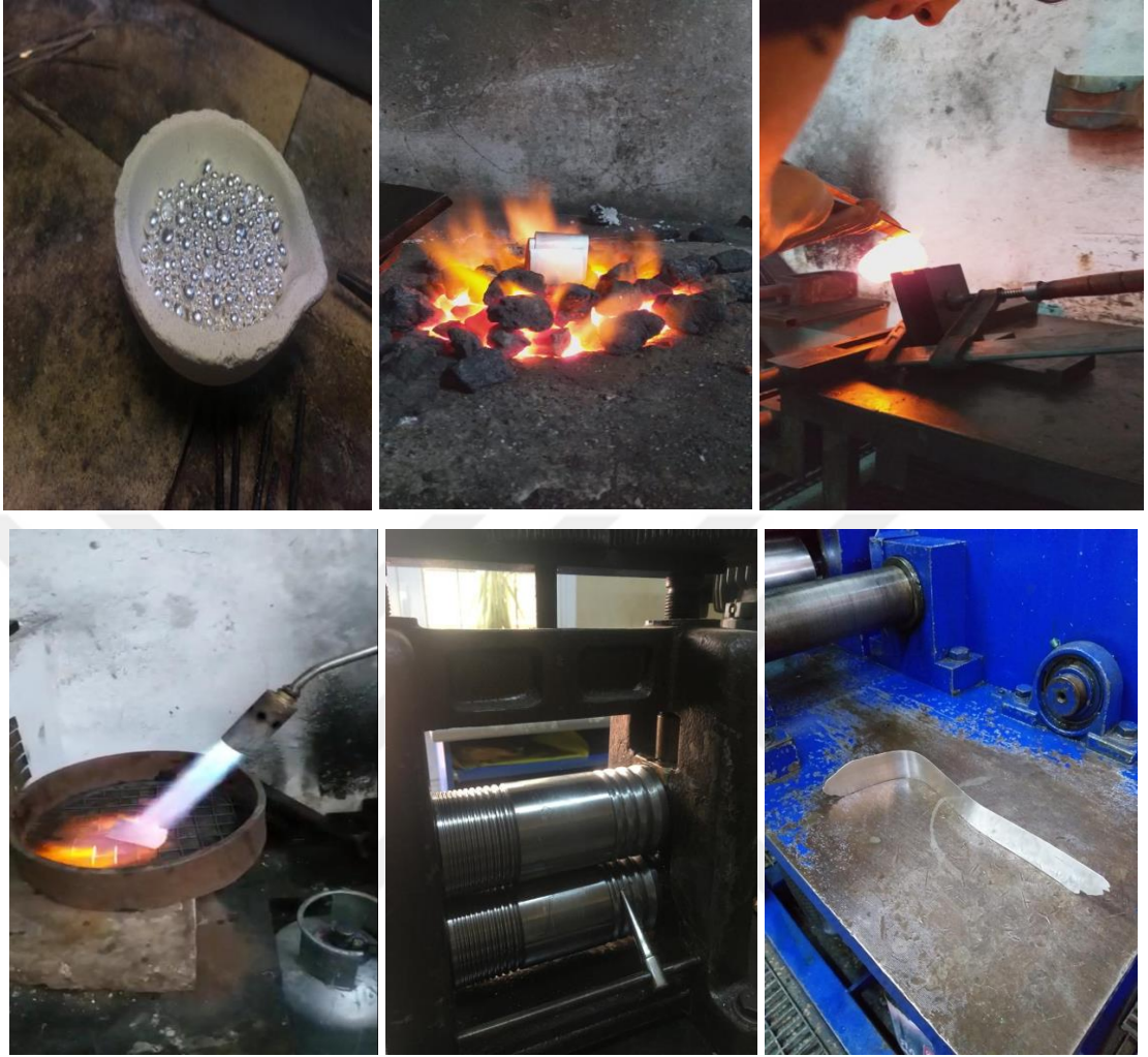
Şekil 33- Gümüşün eritilmesi, tel ve levha dereceye dökülmesi, metalin tavlanması, tel ve plaka haline getirilmesi
