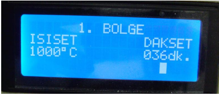
Resim 5.10. Sıcaklık ve süre giriş ekranı
