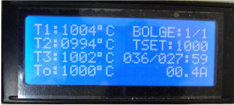
Resim 5.12. Fırının 1000°C’ye ulaştığı andaki ekran görüntüsü
